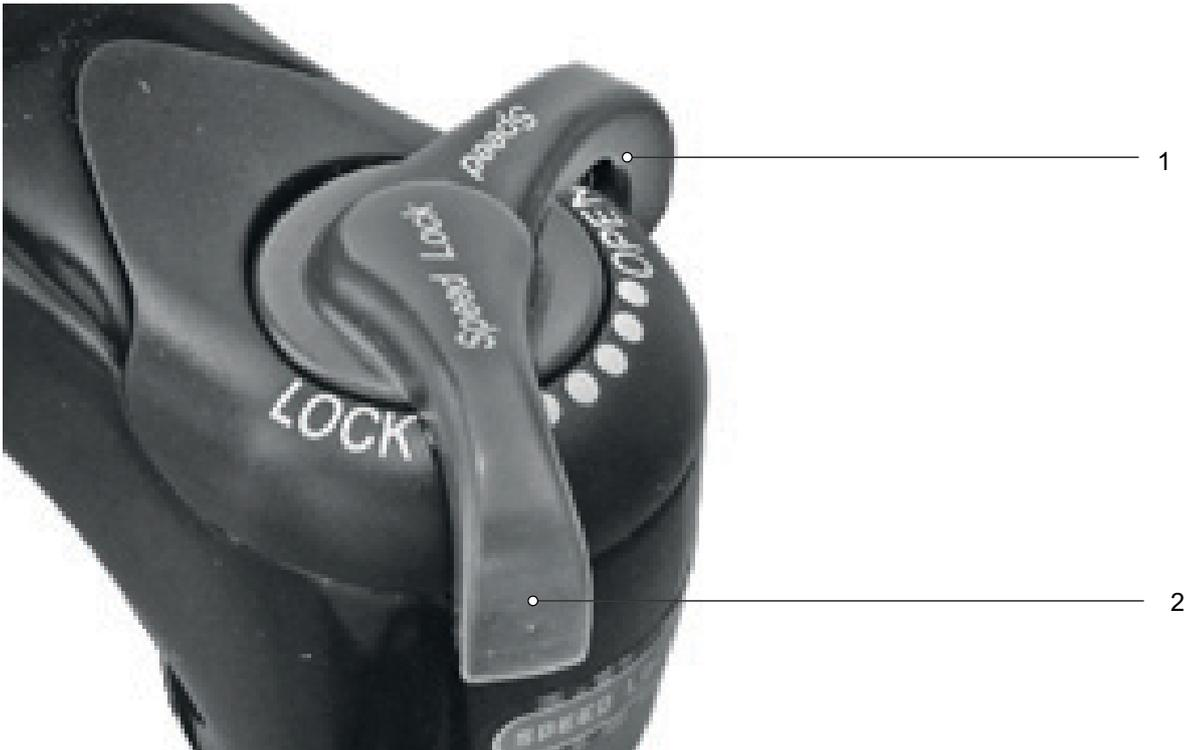
Abbildung 120: Suntour-Druckstufendämpfer in offener (1) und geschlossener (2) Position
