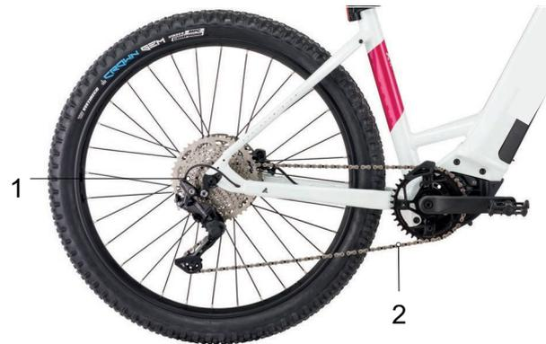
Abbildung 26: Schema Kettenantrieb mit Kettenschaltung
