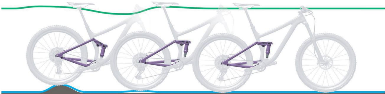
Abbildung 210: Zu schnelles Ausfedern des Hinterbau-Dämpfers
