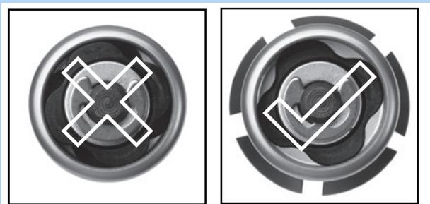
Abbildung 56: Geschlossener und geöffneter Flansch
