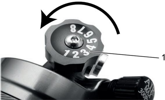
Abbildung 215: Suntour-Druckstufeneinsteller (1) am Hinterbau-Dämpfer
