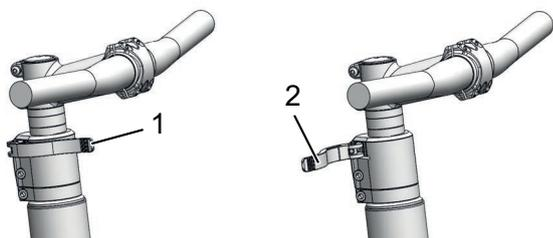
Abbildung 74: Geschlossener (1) und geöffneter (2) Vorbau-Spannhebel, Beispiel All Up
