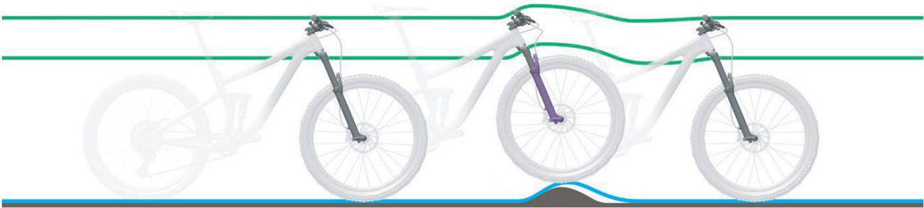
Abbildung 208: Zu harte Dämpfung der Federgabel bei Unebenheiten
