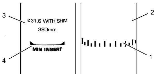
Abbildung 68: Detailansicht Sattelstützen, Beispiele für die Markierung der Mindesteinstecktiefe
