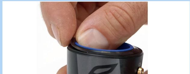
Abbildung 183: Dichtlippenring abziehen
