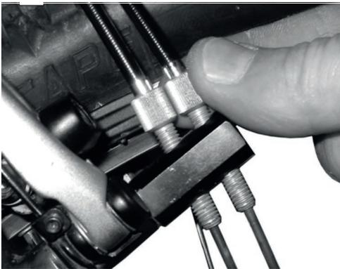
Abbildung 133: ROHLOFF-Naben Versionen mit interner Schaltansteuerung haben die Zugeinsteller am Zuggegenhalter
