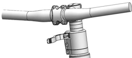
Abbildung 103: Beispiel All Up mit geöffnetem Vorbau-Spannhebel
