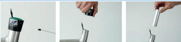
Abbildung 148: Außenhülse und Gleitbuchse ausbauen
