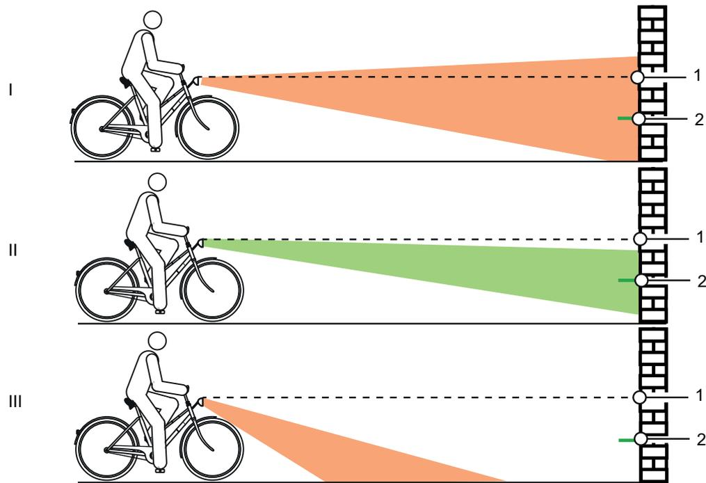
Abbildung 131: Zu hoch (1), korrekt (2) und zu tief (3) eingestelltes Licht
