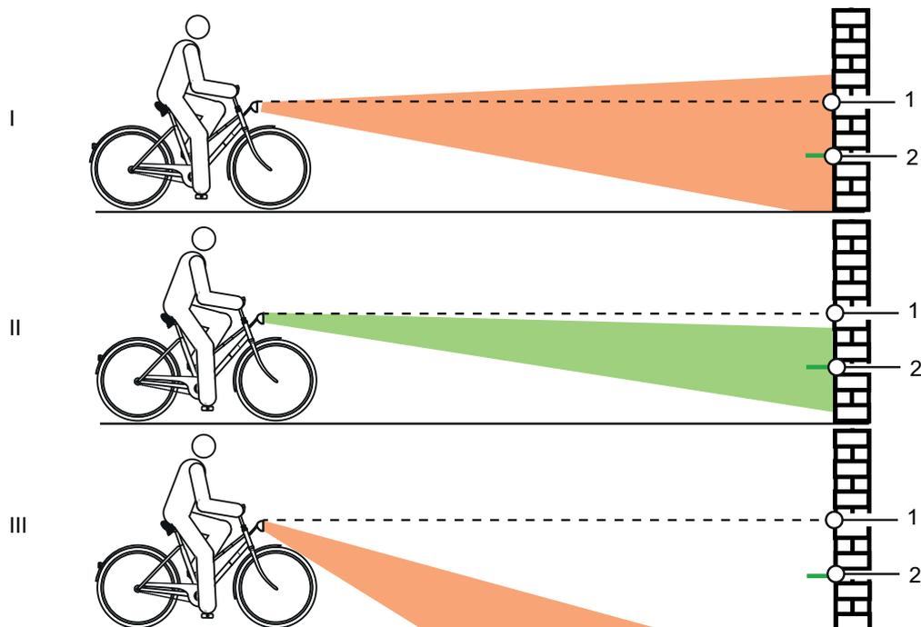
Abbildung 96: Zu hoch (1), korrekt (2) und zu tief (3) eingestelltes Licht
