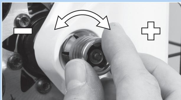
Abbildung 58: Spannung einstellen
