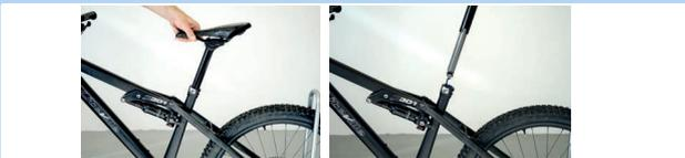
Abbildung 180: Sattelstütze entfernen
