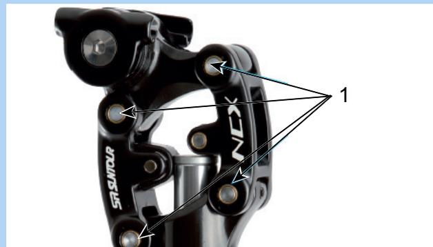
Abbildung 139: Schmierpunkte SR Suntour Feder-Sattelstütze
