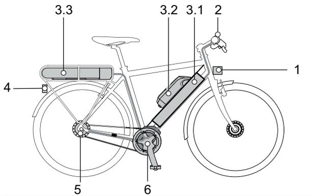
Abbildung 28: Schema elektrisches Antriebssystem mit elektrischen Bauteilen
