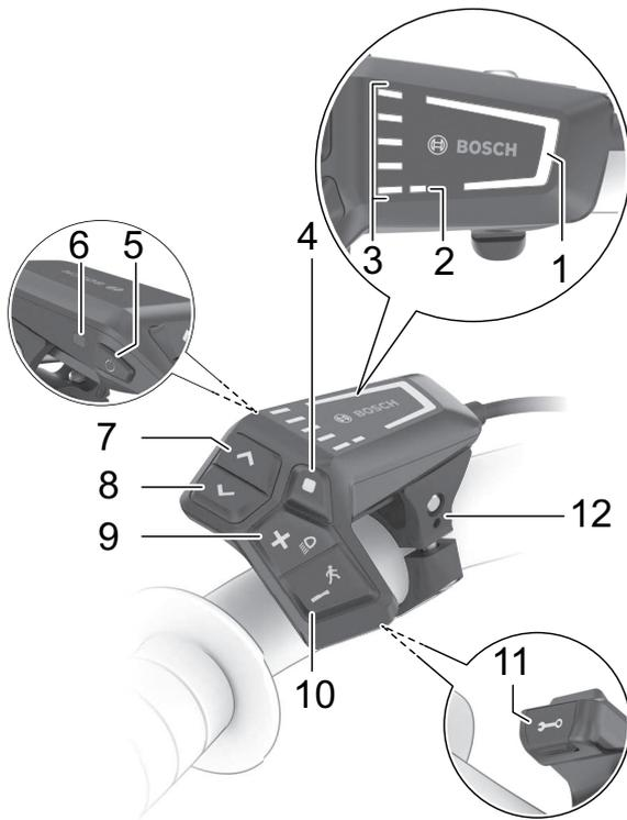
Abbildung 100: Übersicht Bedieneinheit BOSCH LCD Remote
