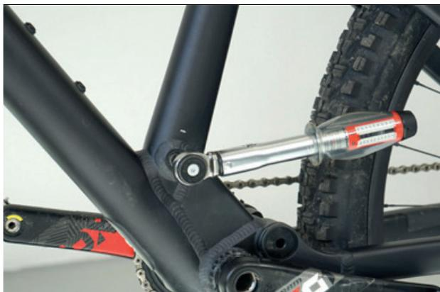
Abbildung 65: Sattelstützen-Achse anziehen
