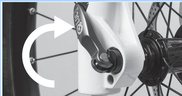
Abbildung 59: Schnellspanner schließen
