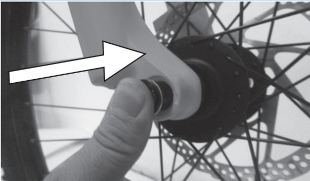
Abbildung 46: Achse in Pfeilrichtung einschieben
