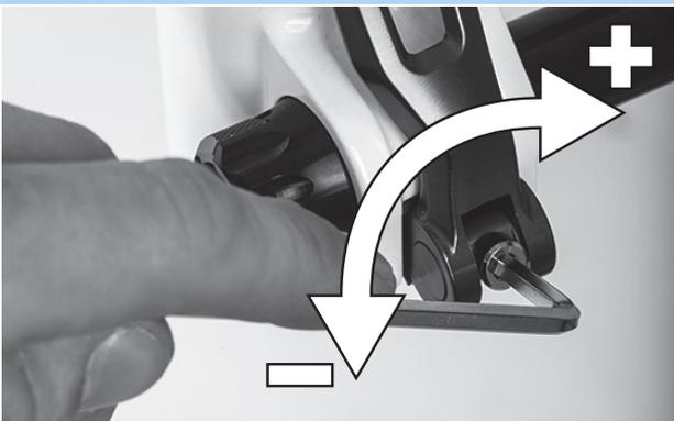
Abbildung 55: Spannkraft des Schnellspanners einstellen
