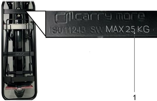
Abbildung 106: Auf dem Gepäckträger ist seine maximale Tragfähigkeit (1) ausgewiesen.
