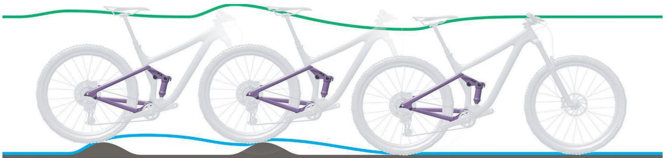
Abbildung 212: Zu langsames Ausfedern des Hinterbau-Dämpfers
