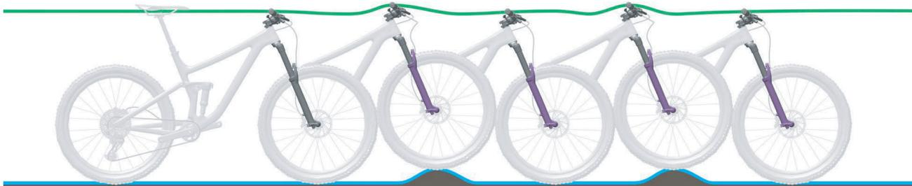
Abbildung 11: Optimales Fahrverhalten der Gabel
