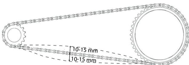
Abbildung 132: Kettenspannung prüfen
