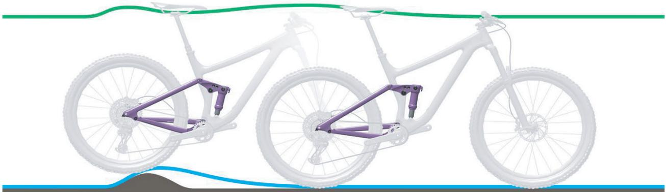
Abbildung 216: Zu harte Dämpfung des Hinterbau-Dämpfers bei Unebenheiten
