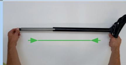
Abbildung 195: Sattelstütze zusammenschieben
