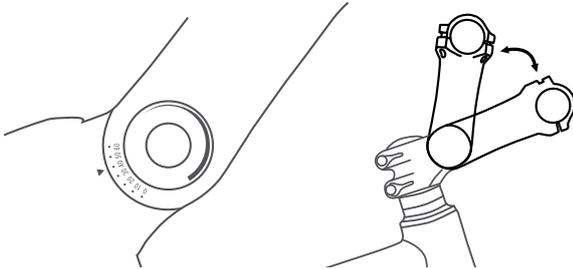
Abbildung 78: Unterschiedliche Versionen von winkelverstellbare Vorbauten
