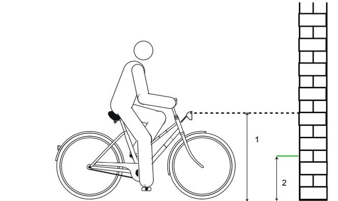
Abbildung 95: Frontleuchtehöhe (1) und die halbe Scheinweferhöhe (2)
