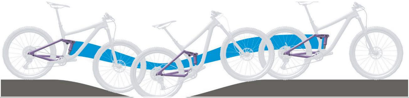
Abbildung 214: Zu weiche Federung des Hinterbau-Dämpfers am Berg
