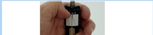
Abbildung 166: Weißer Betätigungsschieber nach unten schieben
