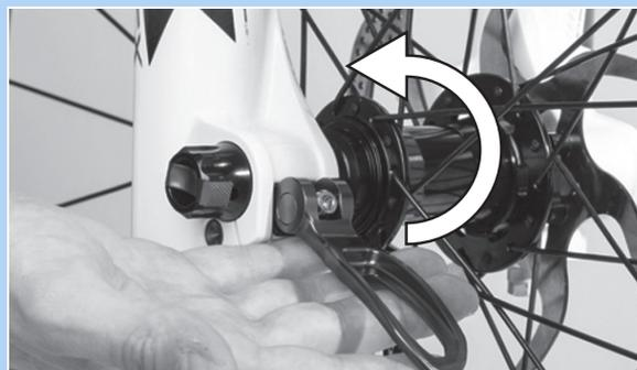
Abbildung 53: Schnellspannhebel in Pfeilrichtung drücken
