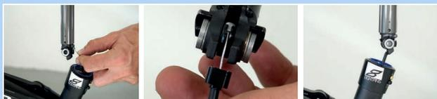
Abbildung 198: Sattelstütze aufhängen und einschieben
