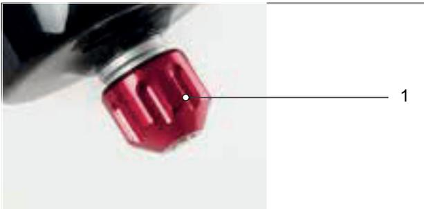
Abbildung 205: Suntour Zugstufen-Schraube (1)
