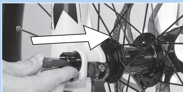
Abbildung 52: Roten Hebel in Pfeilrichtung einschieben
