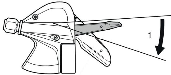
Abbildung 118: Schalten mit Hebel B, Beispiel Schaltung SL-M315
