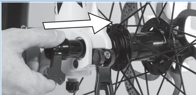
Abbildung 50: Querachse in Pfeilrichtung einschieben
