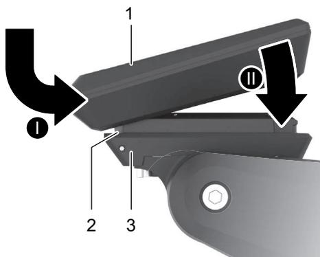
Abbildung 97: Bildschirm einsetzen
