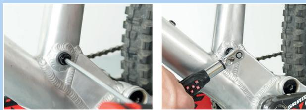
Abbildung 201: Sattelstütze festschrauben
