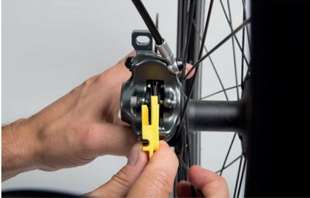
Abbildung 130: Bremsbelag im eingebauten Zustand mithilfe der Transportsicherung prüfen
