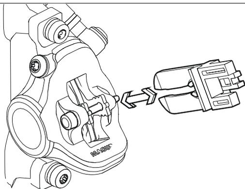
Abbildung 40: Transportsicherung befestigen
