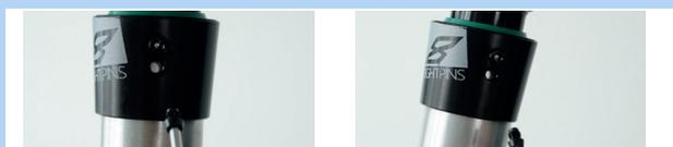
Abbildung 173: Außenhülse befestigen
