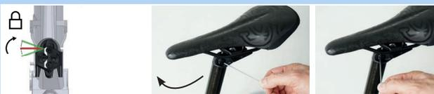
Abbildung 177: Höhenverstellung schließen
