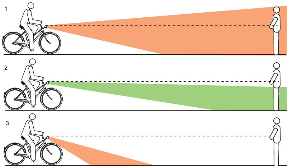
Abbildung 94: Zu hoch (1), korrekt (2) und zu tief (3) eingestelltes Licht
