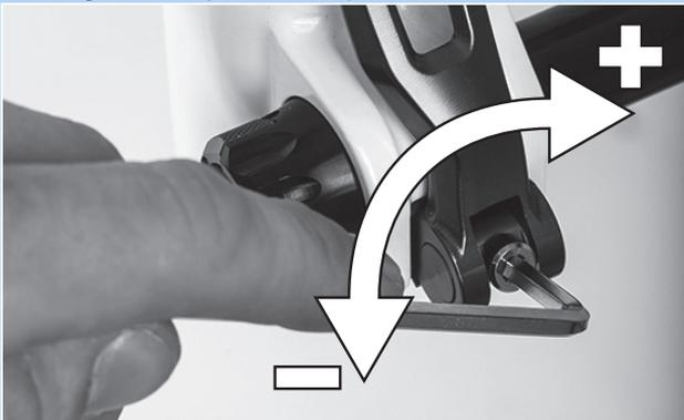
Abbildung 138: Spannkraft des Schnellspanners einstellen
