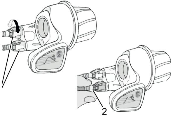
Abbildung 136: Drehgriffschalter mit Einstellhülsen (1) und Spiel der Gangschaltung (2)
