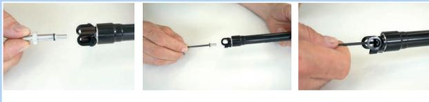
Abbildung 163: Kartusche Ventildeckel befestigen
