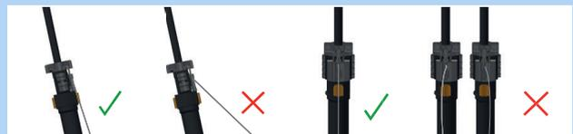
Abbildung 167: Korrekter und falscher Bowdenzug
