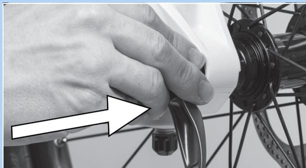
Abbildung 57: Schnellspanner in Pfeilrichtung einschieben
