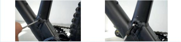
Abbildung 178: Sattelstütze lösen
