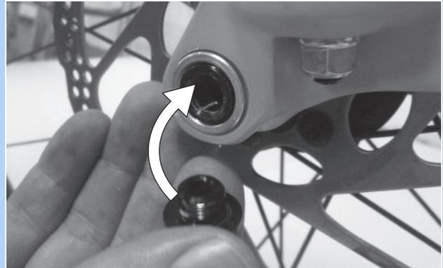
Abbildung 48: Sicherungsschraube einsetzen
