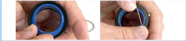
Abbildung 189: Abstreifer einlegen und befestigen
