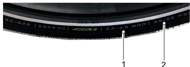
Abbildung 127: Fülldruck in bar (1) und psi (2)
