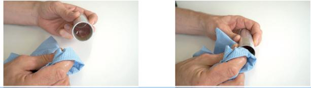
Abbildung 190: Gleitbuchsenrohr reinigen
