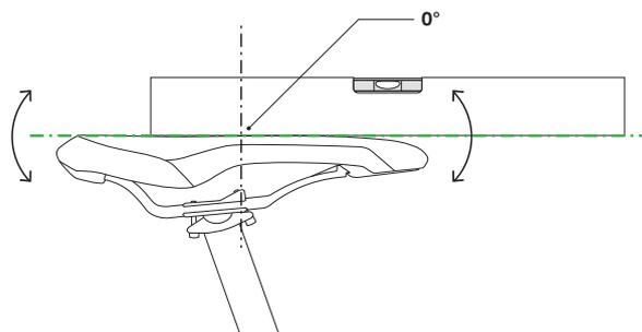
Abbildung 71: Waagerechte Sattelneigung mit 0° Neigung in der Sattelmitte
