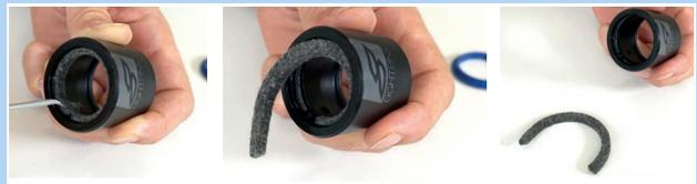
Abbildung 151: Filzring entfernen
