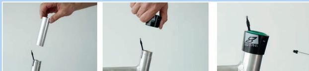
Abbildung 197: Gleitbuchse und Außenhülse einbauen
