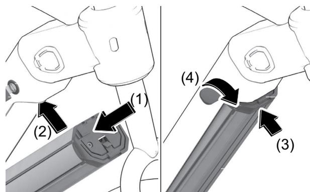
Abbildung 109: Integrierten Akku einsetzen
