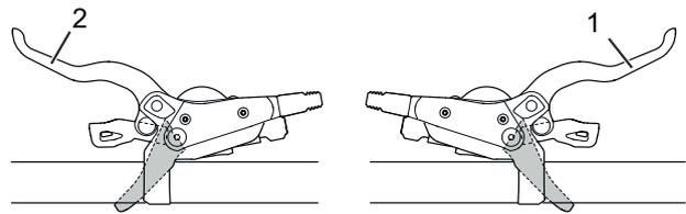
Abbildung 116: Bremshebel hinten (1) und vorne (2), Beispiel SHIMANO Bremse
