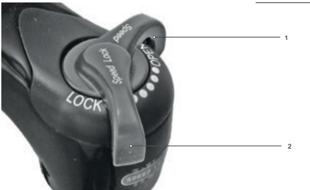
Abbildung 209: Druckstufeneinsteller weicher einstellen
