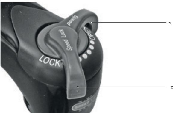
Abbildung 207: Druckstufeneinsteller härter einstellen
