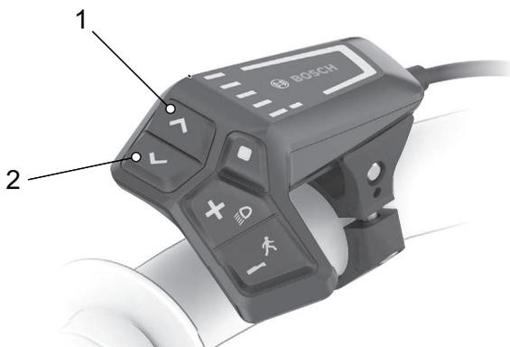
Abbildung 113: Lage Helligkeit erhöhen-Taste (2) und Helligkeit vermindern-Taste (1)
