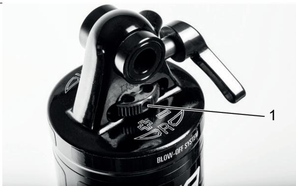
Abbildung 213: Suntour-Zugstufeneinsteller Rad (1) am Hinterbau-Dämpfer
