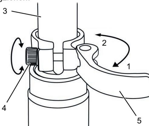
Abbildung 67: Schnellspanner der Sattelstütze öffnen
