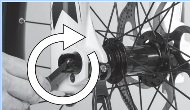
Abbildung 51: Achse in Pfeilrichtung anziehen
