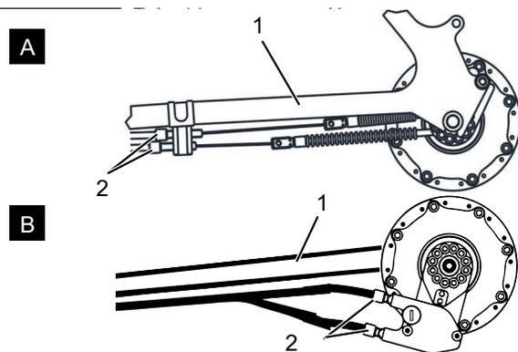
Abbildung 135: Einstellhülsen (2) an zwei alternativen Ausführungen (A und B) einer zweizügigen, seilzugbetätigten Gangschaltung an der Kettenstrebe (1)
