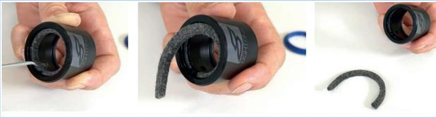
Abbildung 186: Filzring entfernen
