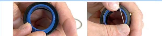
Abbildung 154: Abstreifer einlegen und befestigen
