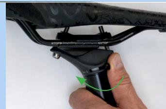
Abbildung 196: Höhenverstellung schließen
