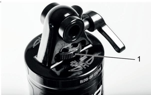
Abbildung 211: Suntour-Zugstufeneinsteller Rad (1) am Hinterbau-Dämpfer
