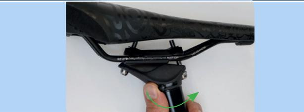
Abbildung 191: Höhenverstellung öffnen
