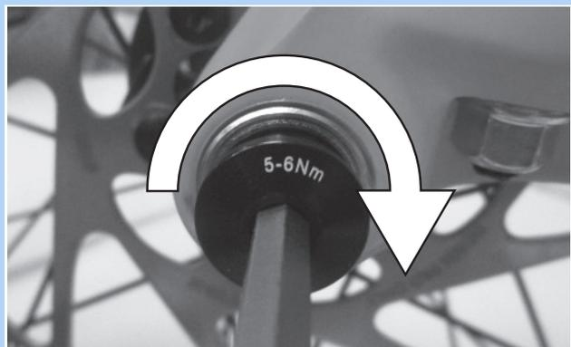
Abbildung 49: Sicherungsschraube anziehen
