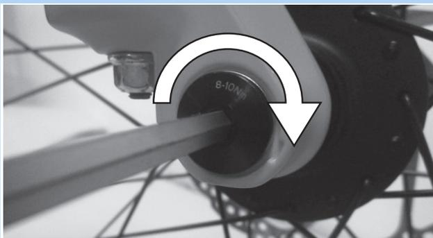
Abbildung 47: Achse in Pfeilrichtung anziehen
