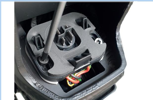
Abbildung 41: Akkuhalter Schrauben lösen
