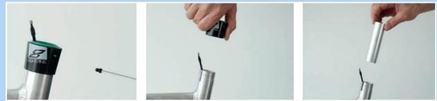
Abbildung 182: Außenhülse und Gleitbuchse ausbauen
