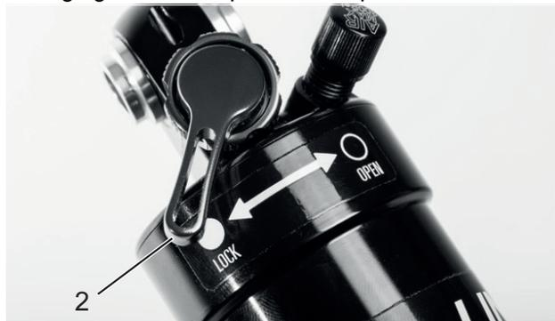
Illustration 78 : Dispositif de réglage de la compression Suntour fermé (2)
