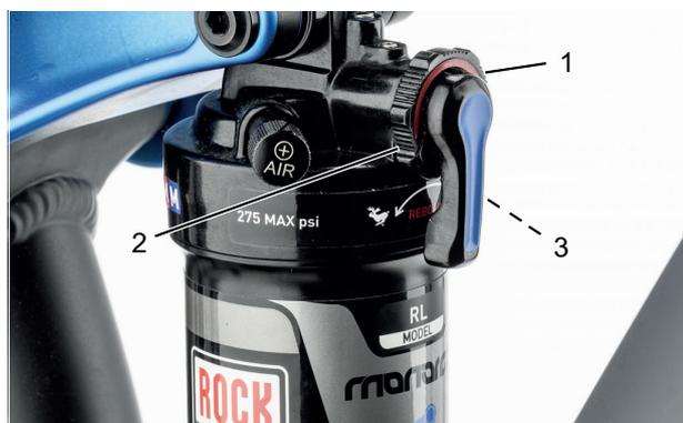
Illustration 79 : Régler la dureté de l'amortisseur de détente (1) de l'amortisseur arrière
