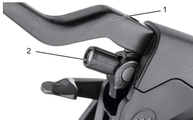
Abbildung 60: Bremshebel (1) der hydraulisch betätigten Felgenbremse mit Einstellschraube (2)
