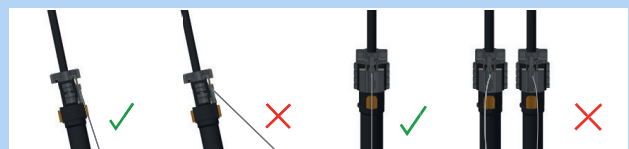
Abbildung 196: Korrekter und falscher Bowdenzug
