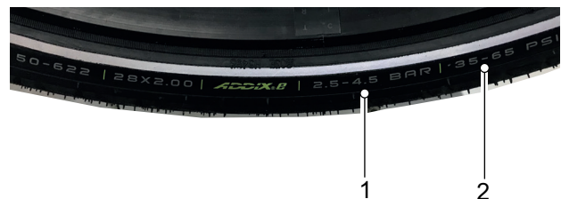
Abbildung 146: Fülldruck in bar (1) und psi (2)
