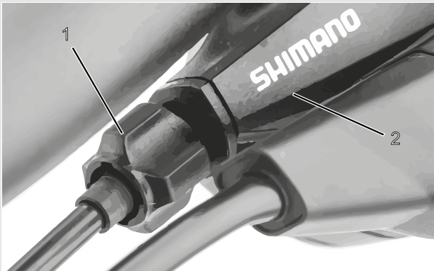
Figura 43: Casquillo de ajuste (1) del cambio de marchas accionado por cable de accionamiento con carcasa de la palanca de cambio (2), ejemplo
