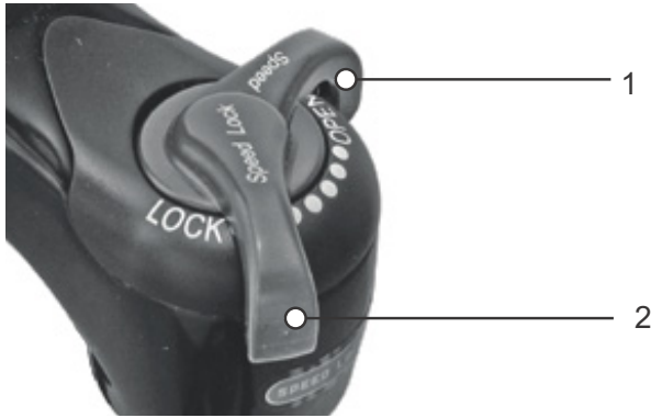
Figura 38: Regulador de niveles de presión Suntour con las posiciones OPEN (1) y LOCK (2)
