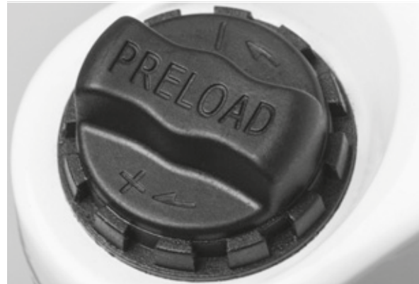
Figura 29: Rueda de ajuste del recorrido negativo de muelle en la corona de la horquilla de suspensión
