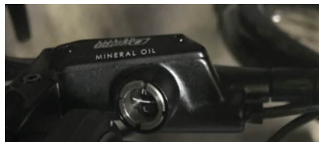
Figura 6: Mirilla para el control del nivel de aceite
