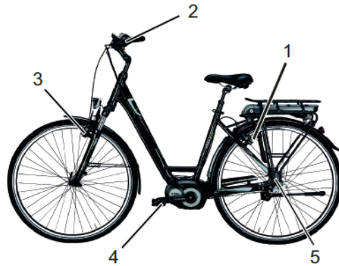
Abbildung 10: Bremssystem eines Fahrrads mit einer Rücktrittbremse, Beispiel
