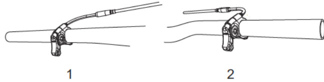
Abbildung 38: Der Betätigungshebel der Sattelstütze kann entweder links (1) oder rechts (2) am Lenker montiert sein.
