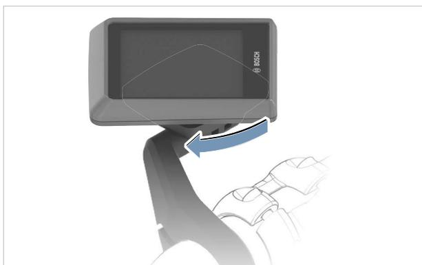
Illustration 121 : Tourner l'écran dans le sens des aiguilles d'une montre
