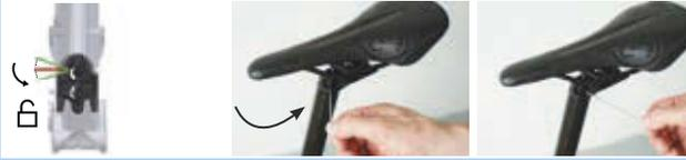
Illustration 201 : Placer le mécanisme de réglage de la hauteur en « position ouverte »
