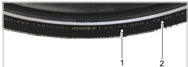
Illustration 166 : Indication de pression des pneus en bar (1) et psi (2)
