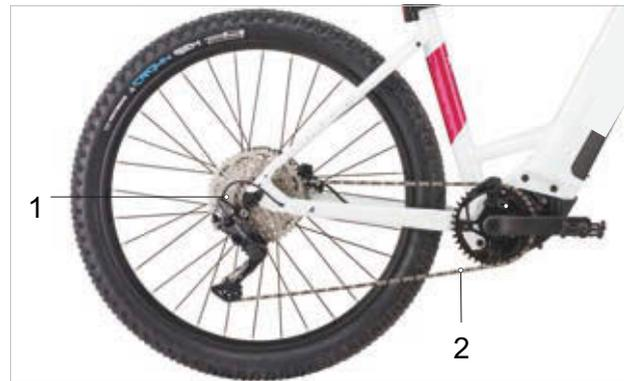
Illustration 42 : Schéma de l'entraînement à chaîne avec dérailleur
