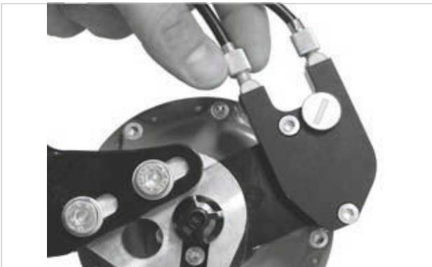
Illustration 195 : Sur les versions de moyeux ROHLOFF avec commande externe du changement de vitesse, le dispositif de réglage de la tension est situé sur le boîtier de câbles qui est placé sur le côté gauche
