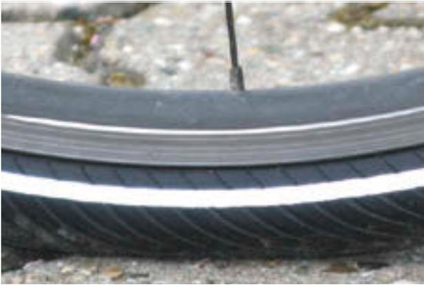
**Illustration 105 : Pression correcte. Le pneu se déforme à peine sous le poids du corps.**
