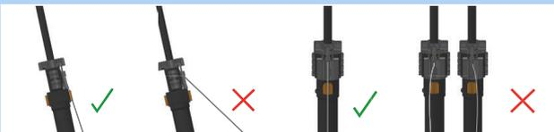
Illustration 228 : Câble Bowden correct et incorrect
