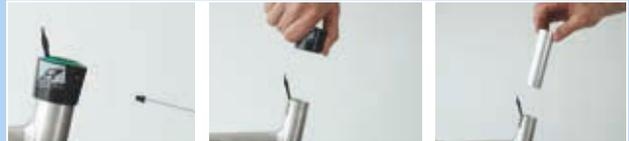
Illustration 243 : Démonter l'enveloppe extérieure et la douille de glissement
