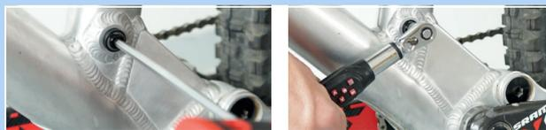
Abbildung 165: Postpin Achse befestigen
