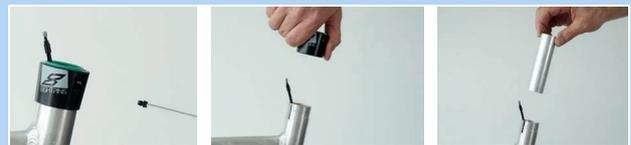
Abbildung 177: Außenhülle und Gleitbuchse ausbauen
