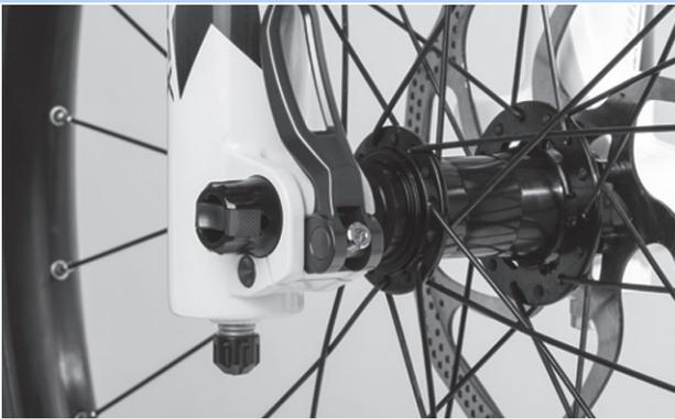
Abbildung 49: Perfekte Lage des Spannhebels
