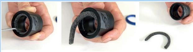
Abbildung 181: Filzring entfernen
