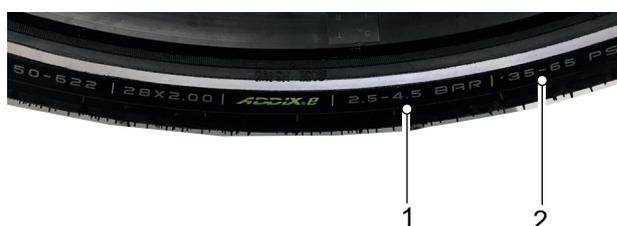
Abbildung 121: Fülldruck in bar (1) und psi (2)
