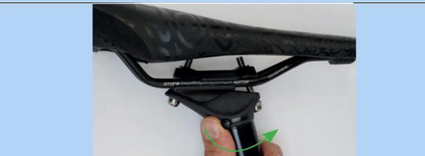
Abbildung 186: Höhenverstellung öffnen
