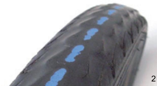
Abbildung 122: Reifen ohne Profil, der noch gefahren werden kann (1), und Reifen mit durchscheinendem Pannenschutz (2), der gewechselt werden muss
