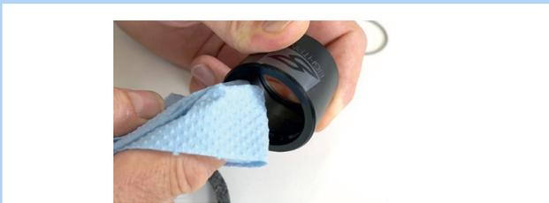
Abbildung 182: Außenhülse reinigen
