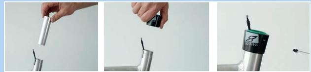
Abbildung 159: Gleitbuchse und Außenhülse einbauen
