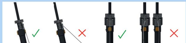
Abbildung 162: Korrekter und falscher Bowdenzug
