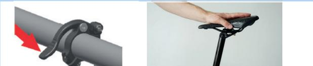
Abbildung 171: Höhe der Sattelstütze einstellen
