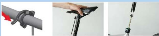
Abbildung 136: Sattelstütze herausziehen
