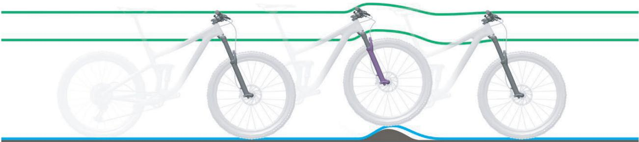
Abbildung 203: Zu harte Dämpfung der Federgabel bei Unebenheiten
