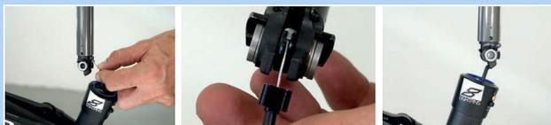
Abbildung 193: Sattelstütze aufhängen und einschieben
