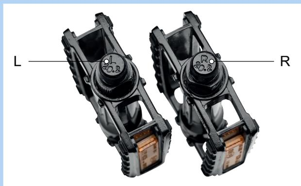
Abbildung 55: Beispiel Kennzeichnung von Pedalen
