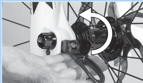
Abbildung 48: Schnellspannhebel in Pfeilrichtung drücken
