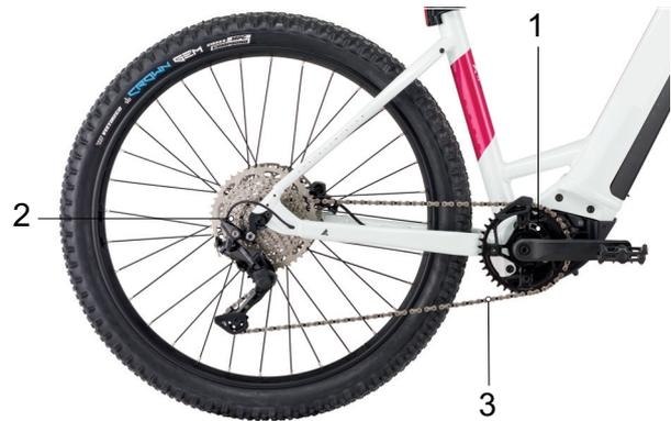
Abbildung 23: Schema Kettenantrieb mit Kettenschaltung
