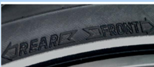
Abbildung 40: Laufrichtungspfeil auf MTB Reifen
