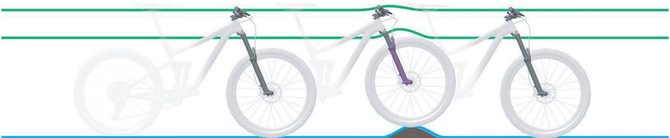
Abbildung 7: Optimales Fahrverhalten der Gabel bei Unebenheiten
