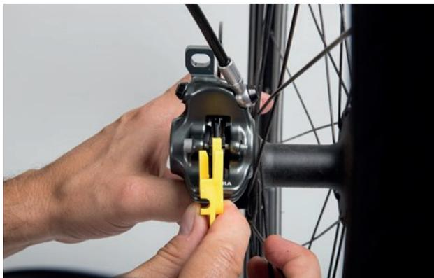
Abbildung 124: Bremsbelag im eingebauten Zustand mithilfe der Transportsicherung prüfen
