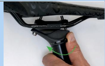
Abbildung 191: Höhenverstellung schließen
