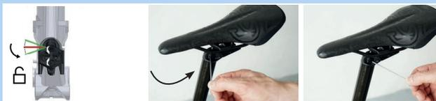
Abbildung 135: Höhenverstellungsbetätigung in „Geöffnete Stellung“ bringen
