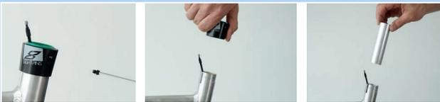
Abbildung 143: Außenhülse und Gleitbuchse ausbauen
