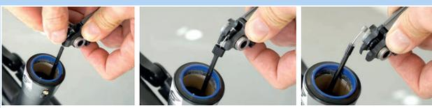
Abbildung 176: Bowdenzug entfernen
