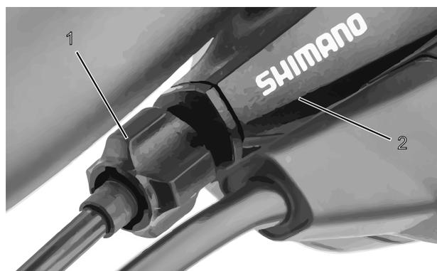
Abbildung 129: Einstellhülse (1) der einzügigen, seilzugbetätigten Gangschaltung mit Schalthebelgehäuse (2), Beispiel
