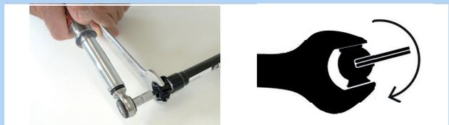
Abbildung 157: Im Uhrzeigersinn einstellen
