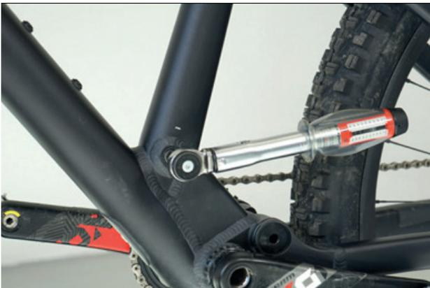
Abbildung 63: Sattelstützen-Achse anziehen
