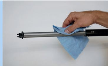
Abbildung 188: Längsführungsnut reinigen
