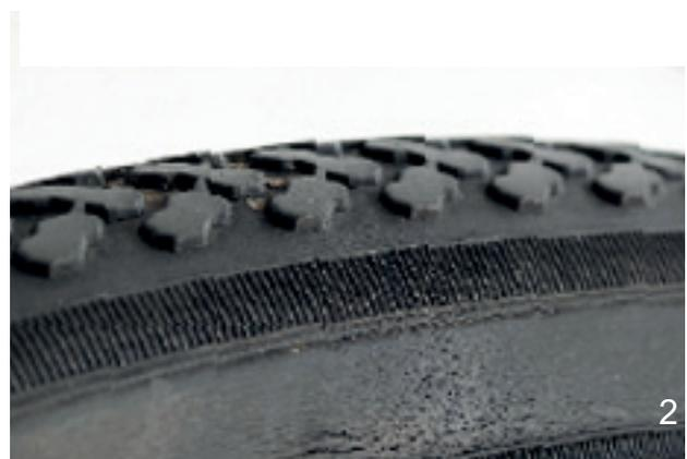
Abbildung 123: Beispiele für Ermüdungsrisse (1) und Alterungsrisse (2)
