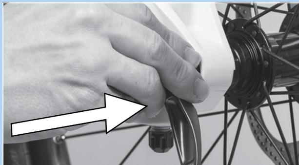
Abbildung 52: Schnellspanner in Pfeilrichtung einschieben
