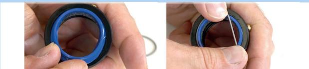
Abbildung 149: Abstreifer einlegen und befestigen
