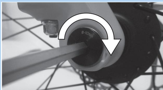
Abbildung 42: Achse in Pfeilrichtung anziehen
