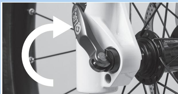
Abbildung 54: Schnellspanner schließen
