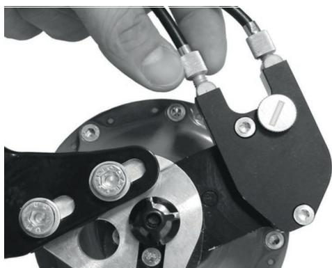
Abbildung 128: ROHLOFF-Naben Versionen mit externer Schaltansteuerung haben die Zugeinsteller an der Seilbox, die sich auf der linken Seite befindet
