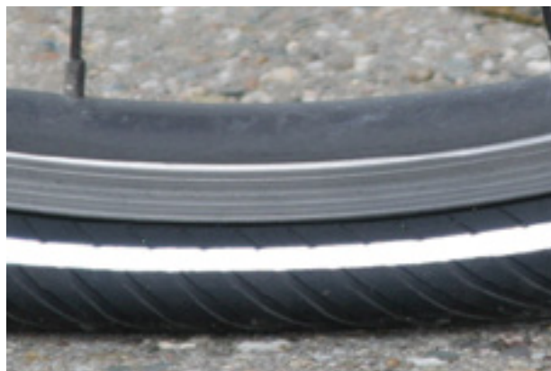
Figura 88: Presión de inflado demasiado baja
