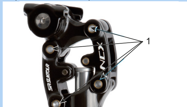
Figura 138: Puntos de lubricación de la tija de sillín de muelle SR Suntour
