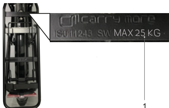
Figura 106: Identificar la capacidad máxima de carga (1) sobre el portaequipajes
