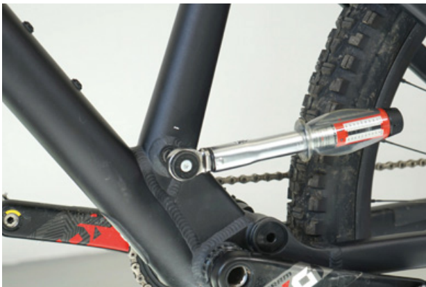
Figura 65: Apriete del eje de la tija de sillín
