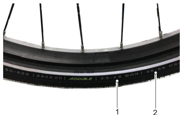
Figura 125: Presión de inflado en bar (1) y psi (2)
