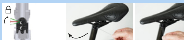
Figura 176: Cierre del ajuste de altura
