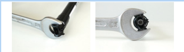
Figura 160: Aseguramiento para evitar el giro
