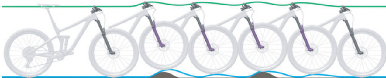
Figura 201: Descompresión demasiado rápida de la horquilla de suspensión
