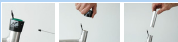
Figura 147: Desmontaje del manguito exterior y del casquillo deslizante
