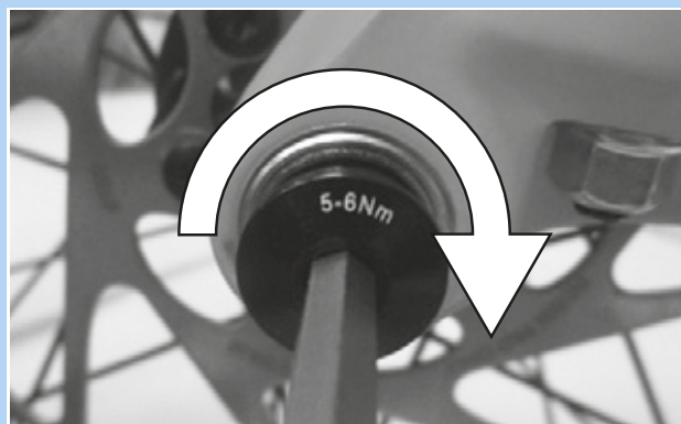
Figura 49: Apriete del tornillo de seguridad
