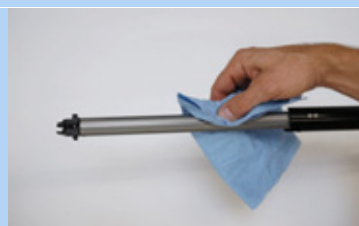
Figura 192: Limpieza de la ranura de guía longitudinal
