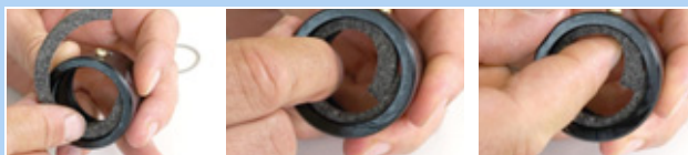
Figura 152: Inserción del anillo de fieltro
