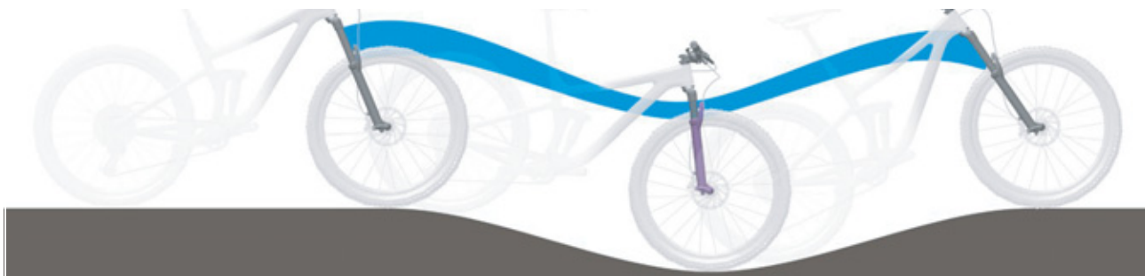
Figura 205: Suspensión de la horquilla de suspensión demasiado blanda en montaña
