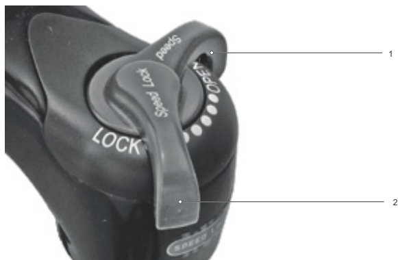
Figura 206: Ajuste para un regulador de niveles de presión más duro
