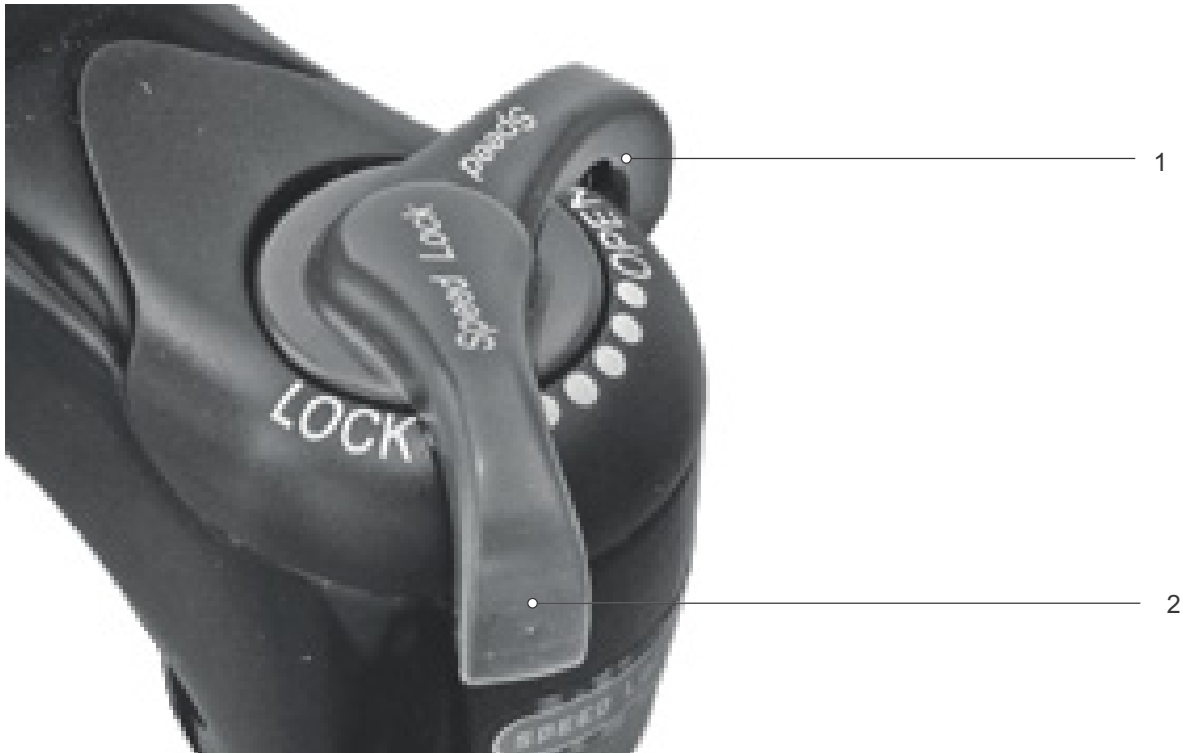
Figura 118: Amortiguador de niveles de presión Suntour en posición abierta (1) y cerrada (2)
