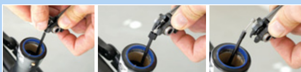
Figura 180: Retirada del cable Bowden
