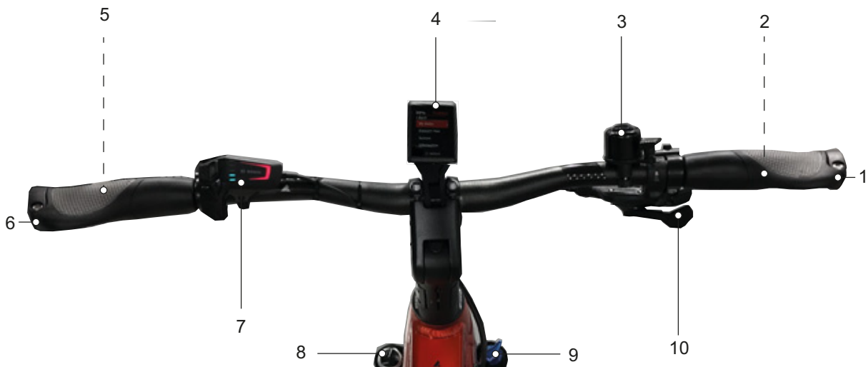
Figura 33: Vista detallada del manillar con BOSCH Kiox300, ejemplo
