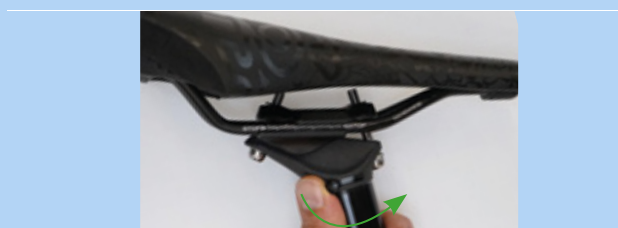
Figura 190: Apertura del ajuste de altura
