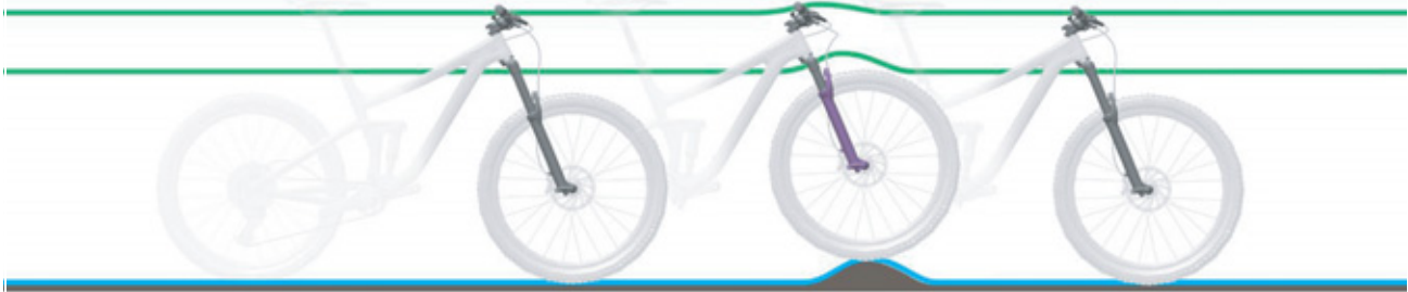
Figura 117: Condición óptima de marcha en terrenos con irregularidades
