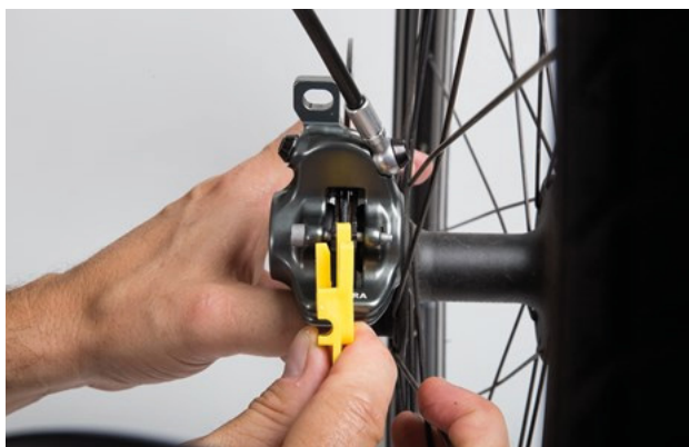
Figura 128: Comprobación de la almohadilla de freno montada con ayuda del seguro de transporte
