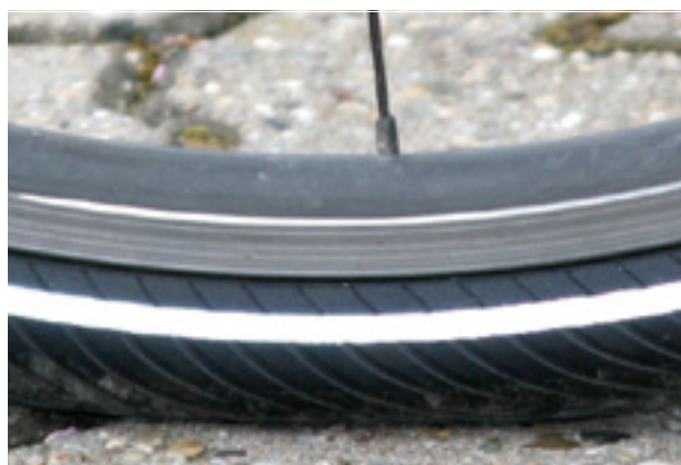
Figura 87: Presión de inflado correcta. La cubierta apenas está deformada bajo la carga del peso corporal
