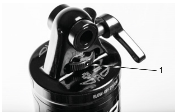
Figura 212: Rueda del regulador de niveles de tracción Suntour (1) en el amortiguador de la horquilla trasera
