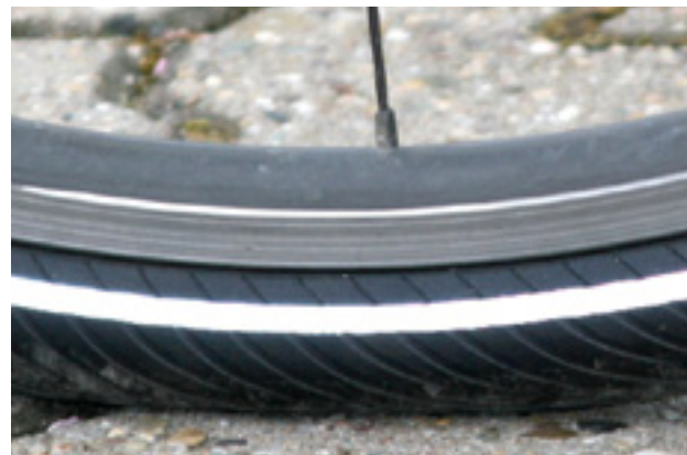
Figura 81: Presión de inflado correcta. La cubierta apenas está deformada bajo la carga del peso corporal
