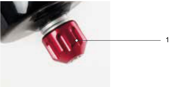
Figura 204: Tornillo de niveles de tracción Suntour (1)
