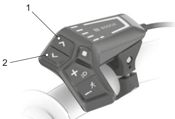
Figura 113: Posición del botón para aumentar el brillo (2) del botón para reducir el brillo (1)
