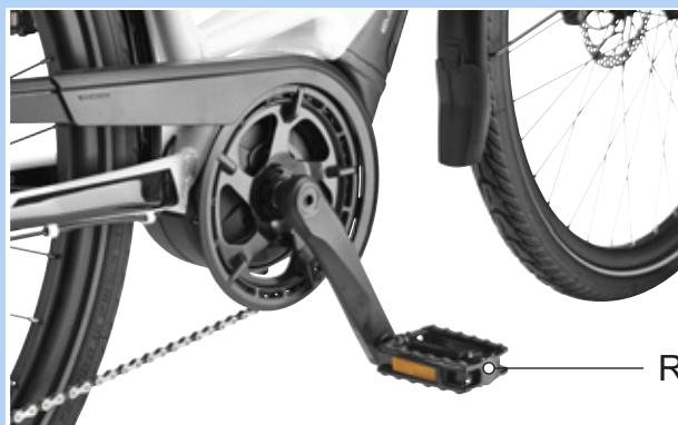
Figura 62: Pedal R en el brazo de manivela derecho
