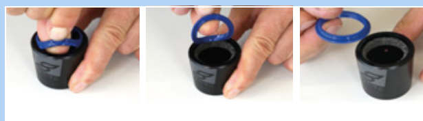
Figura 149: Extracción del rascador
