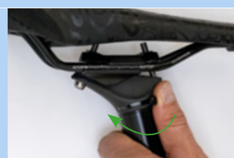
Figura 195: Cierre del ajuste de altura
