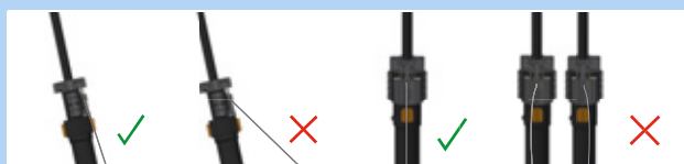
Figura 166: Cable Bowden correcto e incorrecto
