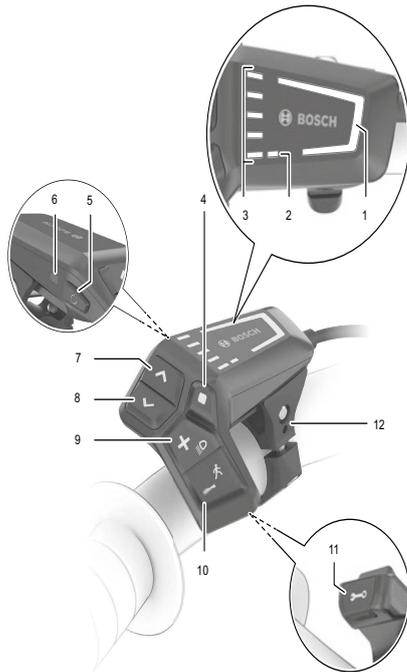
Figura 170: Vista general del ordenador de a bordo BOSCH LED Remote
