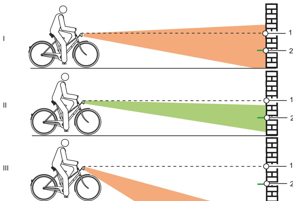
Figura 140: Luz ajustada demasiado alta (1), correctamente (2) y demasiado baja (3)
