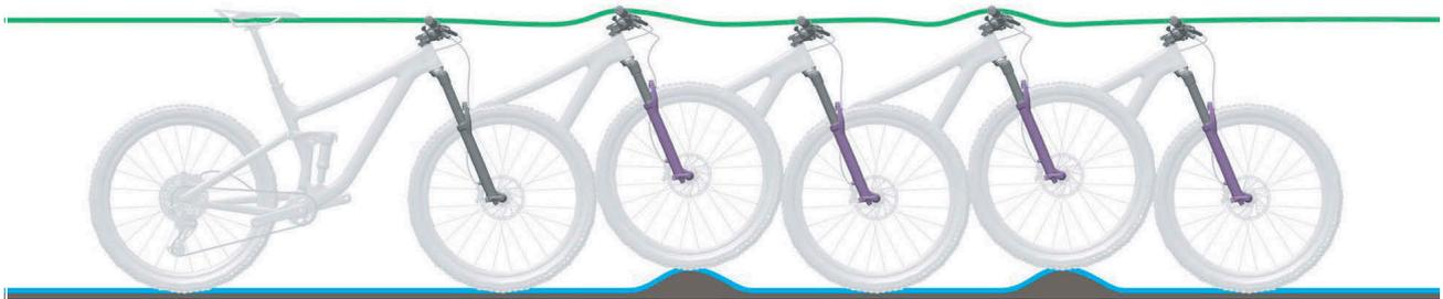
Figura 136: Condición óptima de marcha de la horquilla
