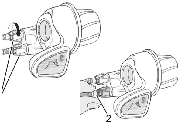
Figura 215: Puño giratorio con casquillos de ajuste (1) con holgura de giro (2)
