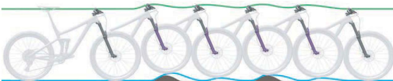
Figura 220: Descompresión demasiado rápida de la horquilla de suspensión
