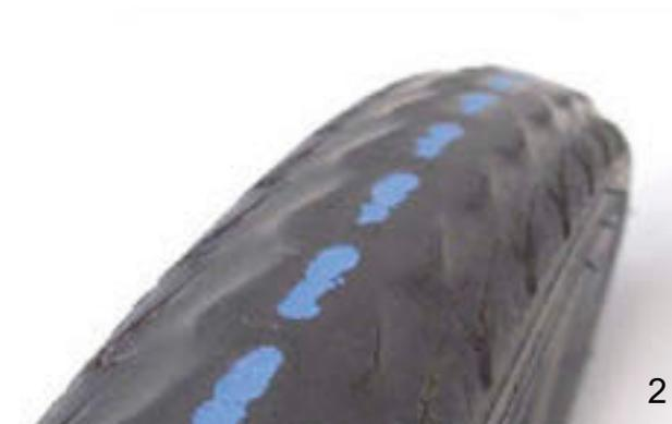
Figura 186: Cubierta sin perfil que puede cambiarse (1); cubierta con protección contra pinchazos visible (2) que tiene que cambiarse
