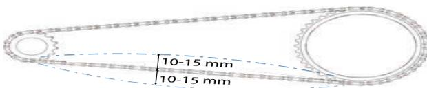
Figura 189: Ejemplo de comprobación de la tensión de la cadena: 5 mm hacia arriba, 10 mm hacia abajo = 15 mm de diferencia
