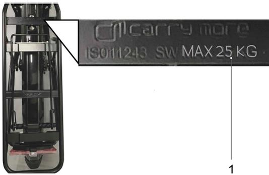
Figura 160: En el portaequipajes se indica la capacidad máxima de carga (1)
