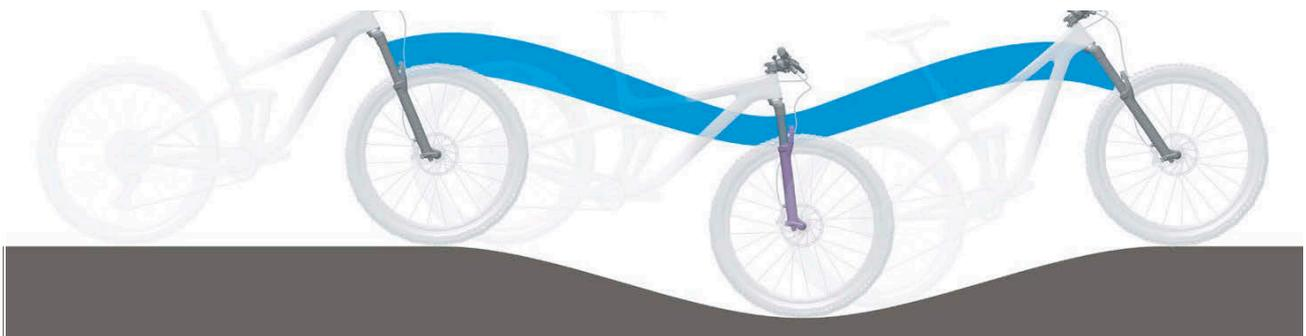
Figura 13: Condición óptima de marcha de la horquilla sobre un terreno accidentado
