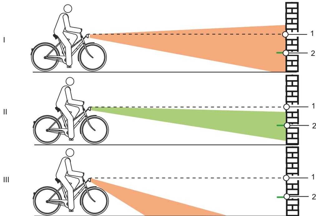
Figura 210: Luz ajustada demasiado alta (1), correctamente (2) y demasiado baja (3)
