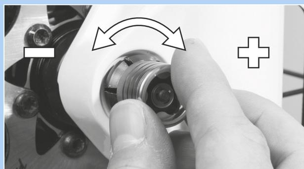
Figura 93: Ajuste de la tensión
