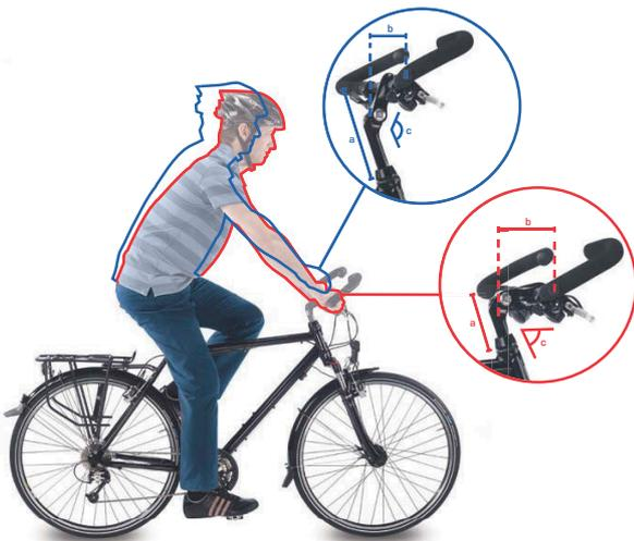
Figura 122: Posición de la bicicleta de ciudad (azul) y la bicicleta de trekking (rojo) mediante la modificación angular
