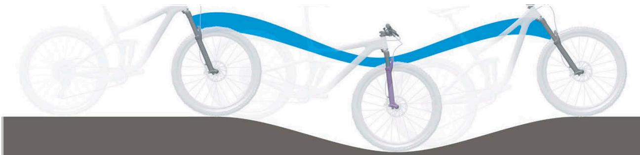
Figura 224: Suspensión de la horquilla de suspensión demasiado blanda en montaña
