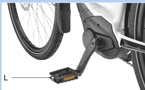
Figura 98: Pedal L en el brazo de manivela izquierdo
