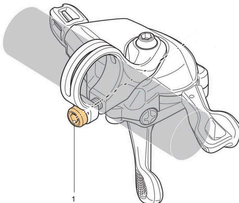
Figura 131: Posición del tornillo de fijación de la palanca de cambio SHIMANO (1)
