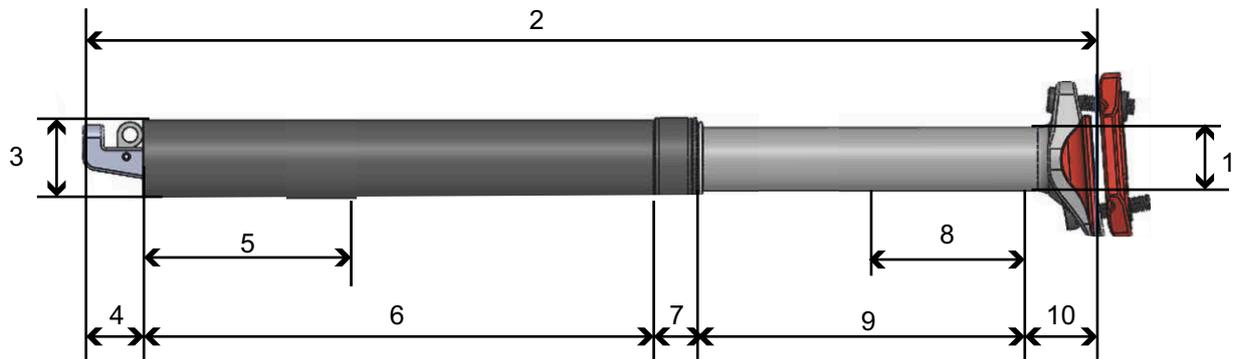
Figura 64: Dimensiones tija de sillín LIMOTEC, A3/A3 Plus
