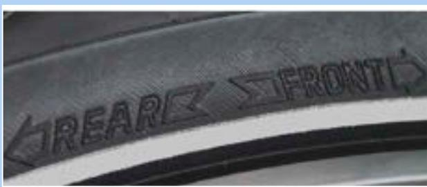
Figura 96: Flecha de sentido de la marcha en cubiertas de MTB
