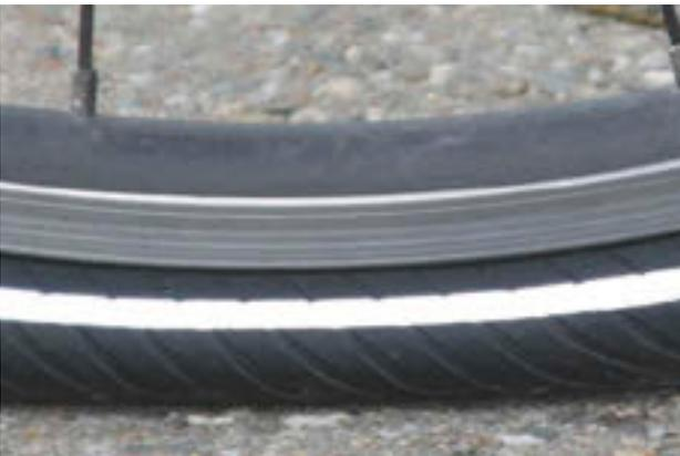
**Figura 125:** Presión de inflado demasiado baja
