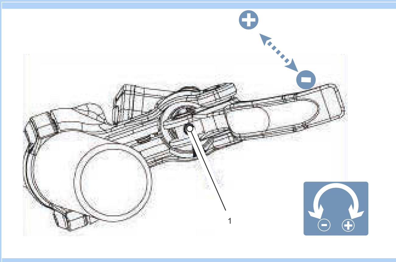
Figura 130: Posición del tornillo de ajuste (1)
