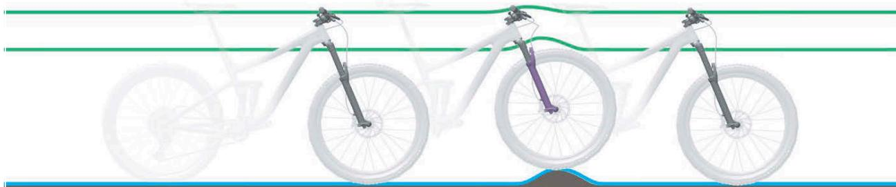
Figura 134: Condición óptima de marcha de la horquilla en caso de irregularidades
