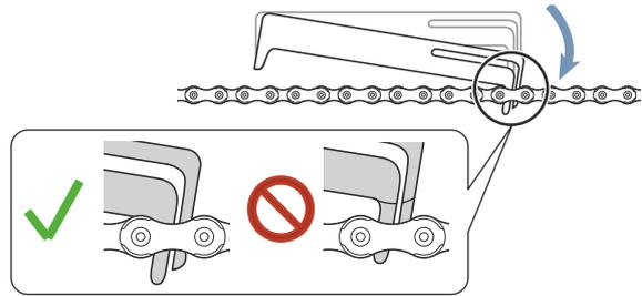
Figura 195: El calibre de medición se inserta
