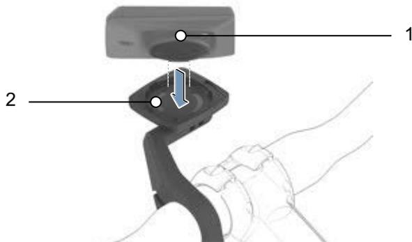
Figura 143: Colocación de la pantalla
