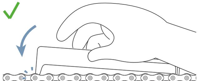
Figura 197: El calibre de medición no cabe
