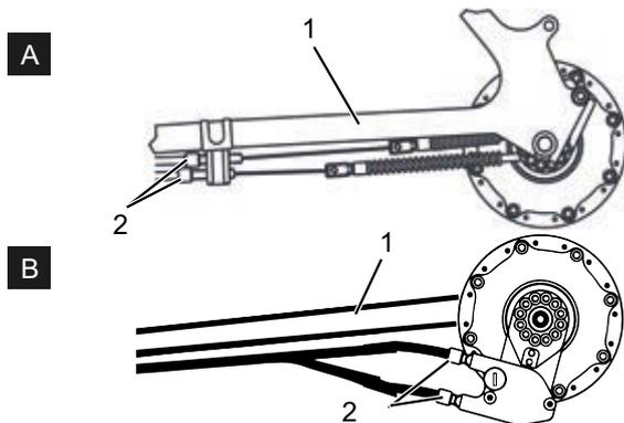
Figura 214: Casquillos de ajuste (2) en dos versiones alternativas (A y B) de un cambio de marchas accionado por cable de accionamiento, de dos cables en la vaina (1)
