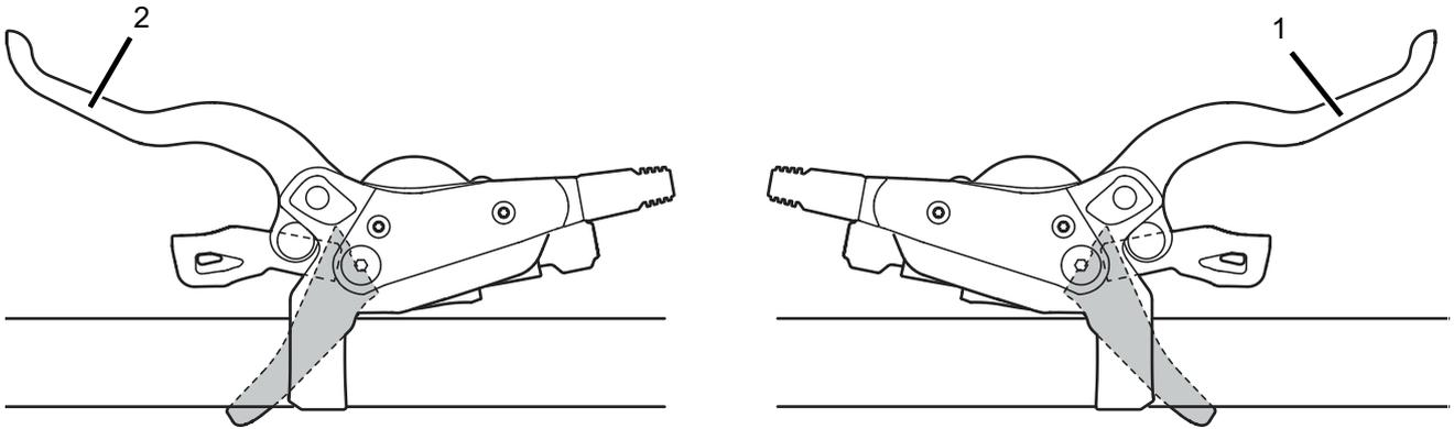
Figura 57: Freno de mano de la rueda trasera (1) y de la rueda delantera (2), ejemplo de freno SHIMANO
