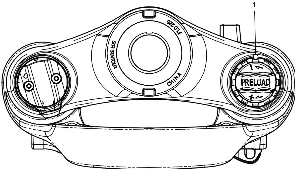
Figura 135: Ejemplo SR SUNTOUR, rueda de ajuste SAG en la corona
