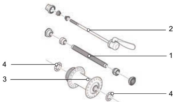
**Figura 30:** Ejemplo de buje de la rueda delantera, SHIMANO
