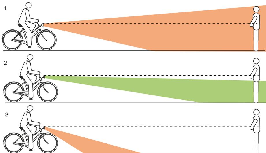
Figura 138: Luz ajustada demasiado alta (1), correctamente (2) y demasiado baja (3)
