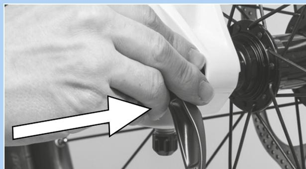
Figura 92: Inserción del cierre rápido en la dirección de la flecha
