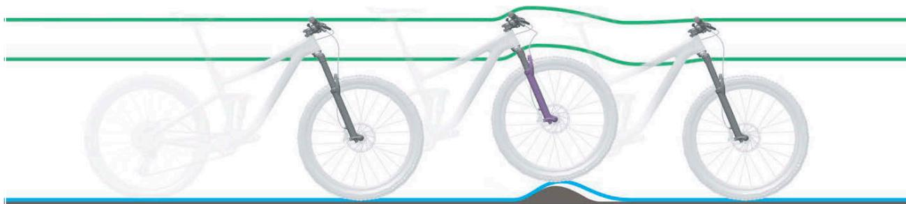
Figura 225: Amortiguación de la horquilla de suspensión demasiado dura en caso de irregularidades
