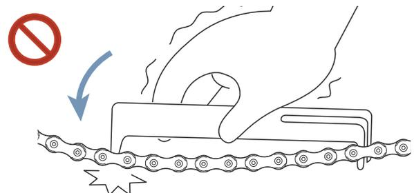
Figura 198: El calibre de medición cabe
