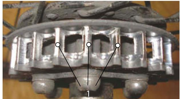
Figura 202: Fotografía de ejemplo de un perfil dentado desgastado
