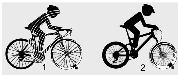
Figura 8: Sin suspensión (1) y con suspensión (2)
