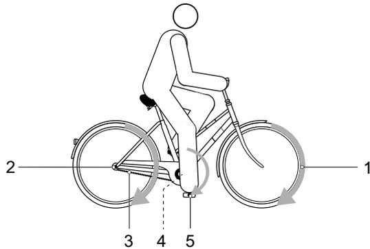
Figura 44: Esquema del sistema de accionamiento mecánico
