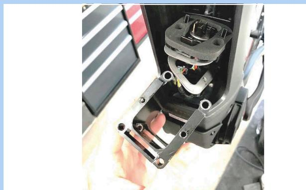
Figura 70: Extracción del adaptador PowerTube
