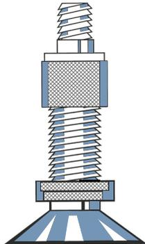
Figura 27: Válvula Dunlop
