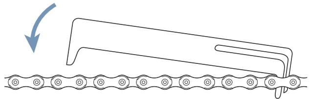
Figura 196: Bajar el calibre de medición a la izquierda
