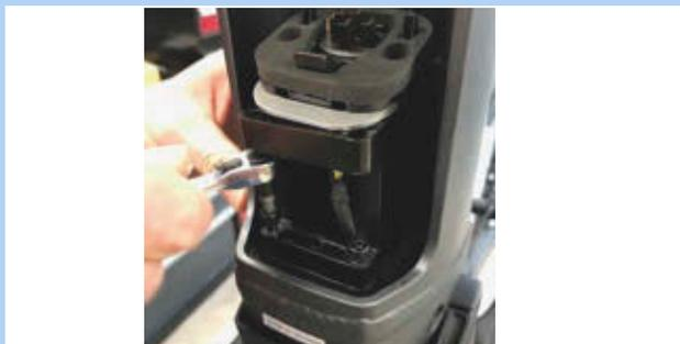
Figura 68: Retirada de los tornillos hexagonales de 4 mm
