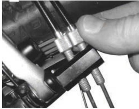
Figura 212: Las versiones de bujes ROHLOFF con activación de cambio interna tienen los dispositivos de ajuste de tensión en el contraapoyo de tensión
