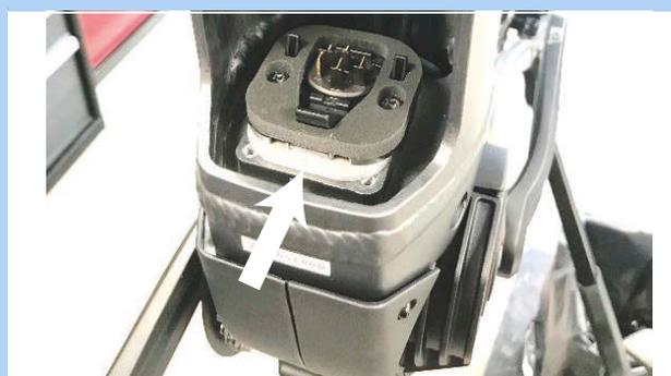
Figura 71: Placas adaptadoras montadas
