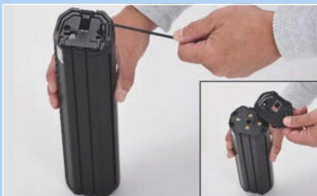
Figura 76: Desmontaje de la interfaz superior
