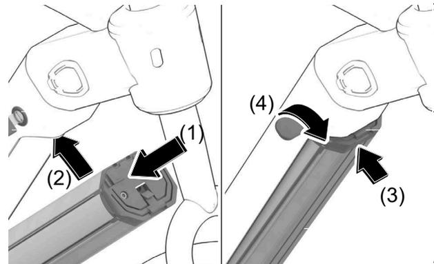
Figura 168: Inserción de la batería integrada
