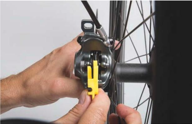
Figura 188: Comprobación de la almohadilla de freno montada con ayuda del seguro de transporte
