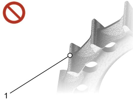
Figura 201: Perfil dentado desgastado
