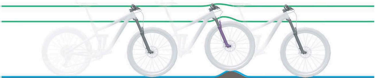
Figura 14: Condición óptima de marcha de la horquilla en caso de irregularidades
