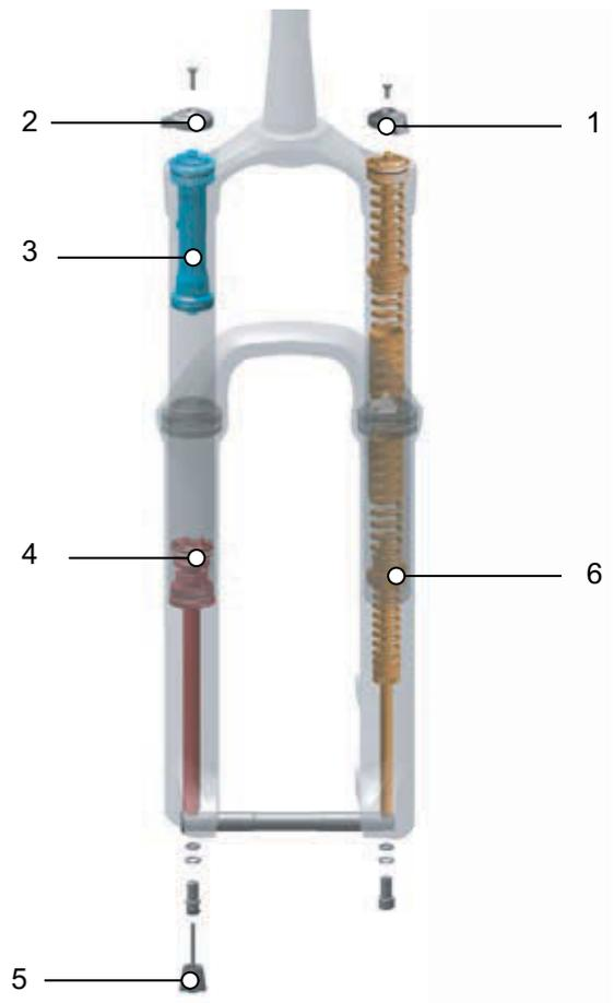
Figura 11: Construcción interna de una horquilla de suspensión de muelle
