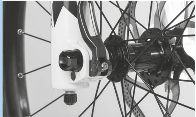
Figura 216: Ajuste de la fuerza de tensado del cierre rápido
