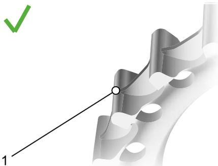
Figura 200: Perfil dentado óptimo
