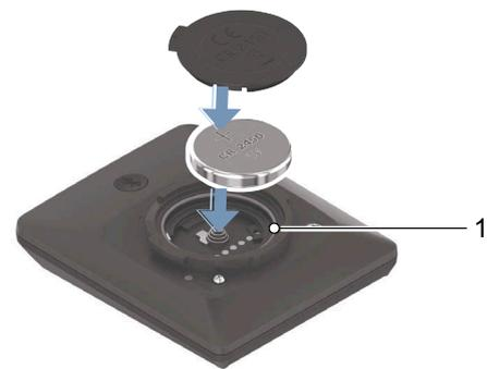
Figura 142: Colocación la batería con la junta de goma correctamente colocada (1)
