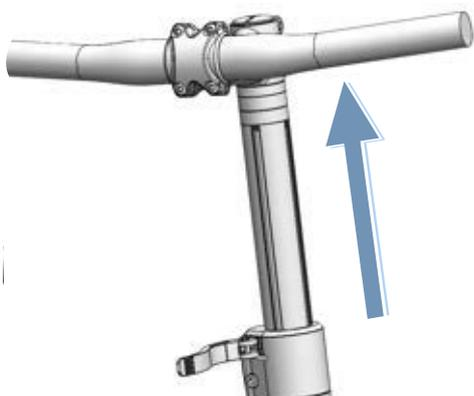
Figura 158: Ejemplo de All Up estirado hasta la posición más alta
