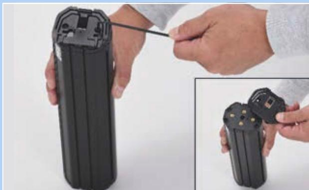
Figura 73: Desmontaje de la interfaz superior
