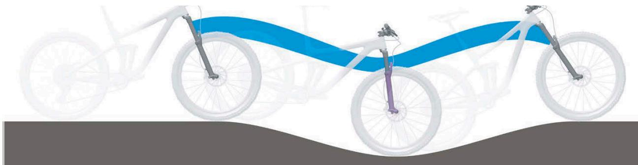
Figura 133: Condición óptima de marcha de la horquilla sobre un terreno accidentado
