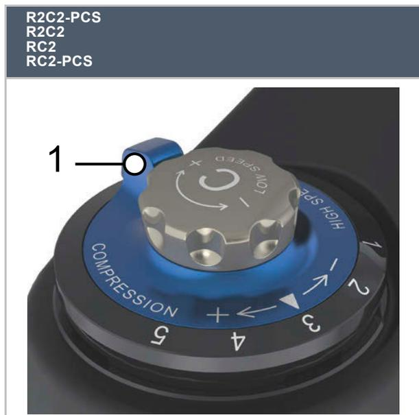
Tabla 67: Palanca de alta velocidad (1) de la horquilla de suspensión SR Suntour en la corona
