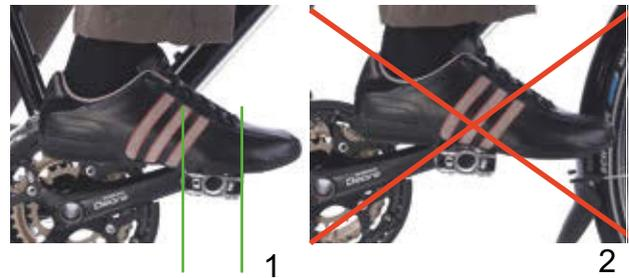
Figura 161: Posición correcta (1) e incorrecta (2) del pie sobre el pedal
