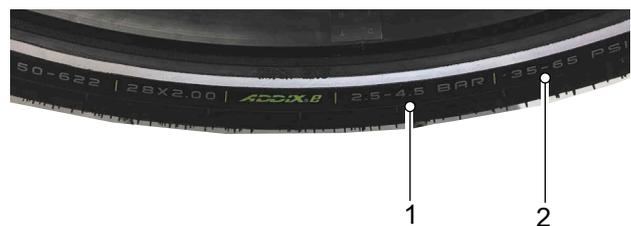
Figura 185: Indicación de presión de inflado en bar (1) y psi (2)
