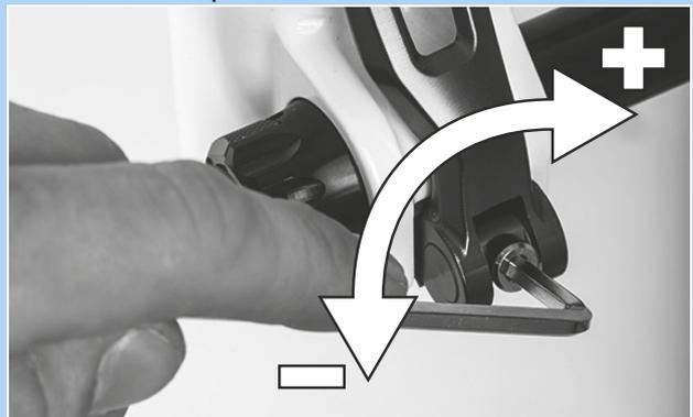
Figura 217: Ajuste de la fuerza de tensado del cierre rápido
