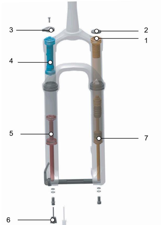
Figura 10: Construcción interna de una horquilla de suspensión neumática
