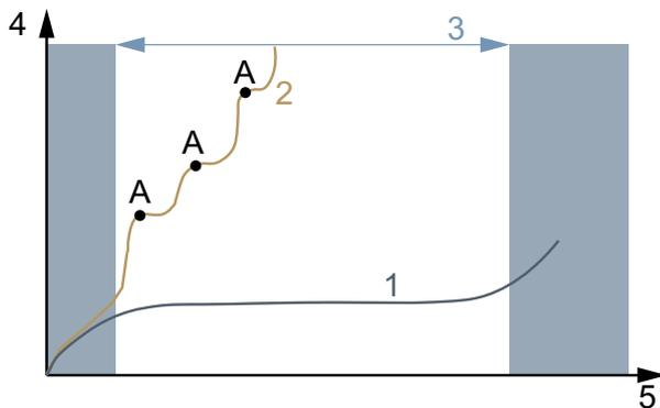
Figura 182: Diagrama de desgaste, vida útil (x) con respecto a desgaste de materiales (y)
