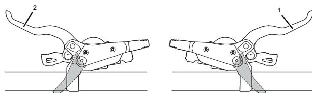
Figura 175: Freno de mano trasero (1) y delantero (2), ejemplo freno SHIMANO
