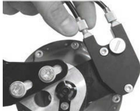
Figura 213: Las versiones de bujes ROHLOFF con activación de cambio externa tienen los dispositivos de ajuste de tensión en la caja de cables que se encuentra en el lado izquierdo
