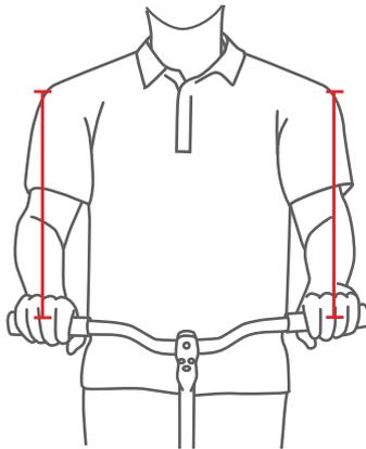
Figura 115: Cálculo de la anchura óptima del manillar
