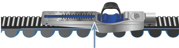
Figura 204: Calibre de comprobación en la correa
