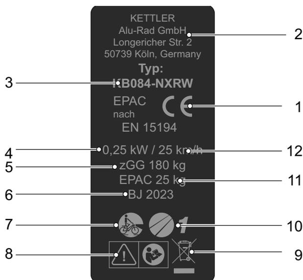
Figura 2: Ejemplo Placa indicadora de tipo KETTLER
