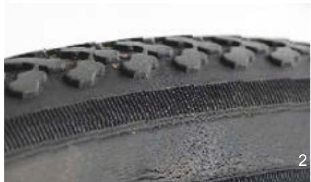
Figura 187: Ejemplos de fisuras por fatiga (1) y fisuras por envejecimiento (2)
