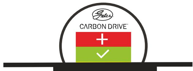
Figura 209: Ejemplo: En el borde amarillo inferior, por ello reducir la tensión de correa ligeramente
