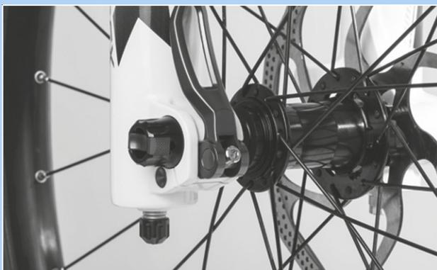
Figura 89: Posición perfecta de la palanca tensora
