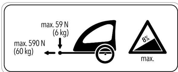
Figura 147: Placa indicadora de remolque
