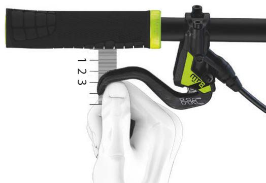
Figura 129: Posicionamiento del freno de mano
