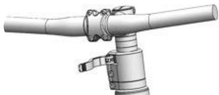
Figura 157: Ejemplo de All Up con palanca tensora de la potencia abierta
