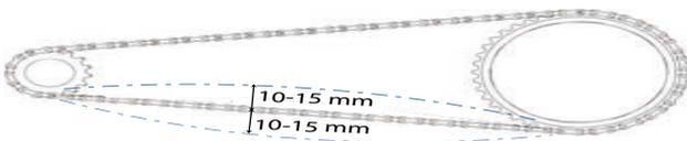
Figura 211: Comprobación de la tensión de la cadena
