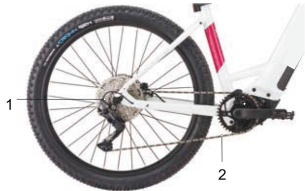
Figura 45: Esquema de la transmisión por cadena con cambio de cadena
