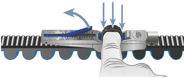
Figura 205: Presionar el calibre de comprobación hacia abajo
