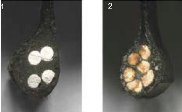
Figura 25: Núcleo de acero (1) y núcleo de Kevlar (2)
