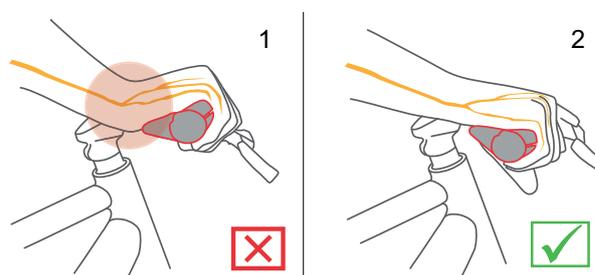
Figura 123: Posición incorrecta (1) y correcta (2) del puño
