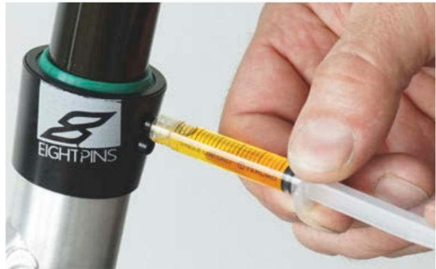
Figura 184: Lubricación de la tija de sillín eightpins
