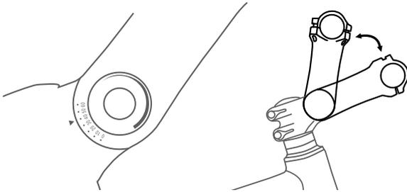
Figura 121: Diferentes versiones de potencias con ajuste angular
