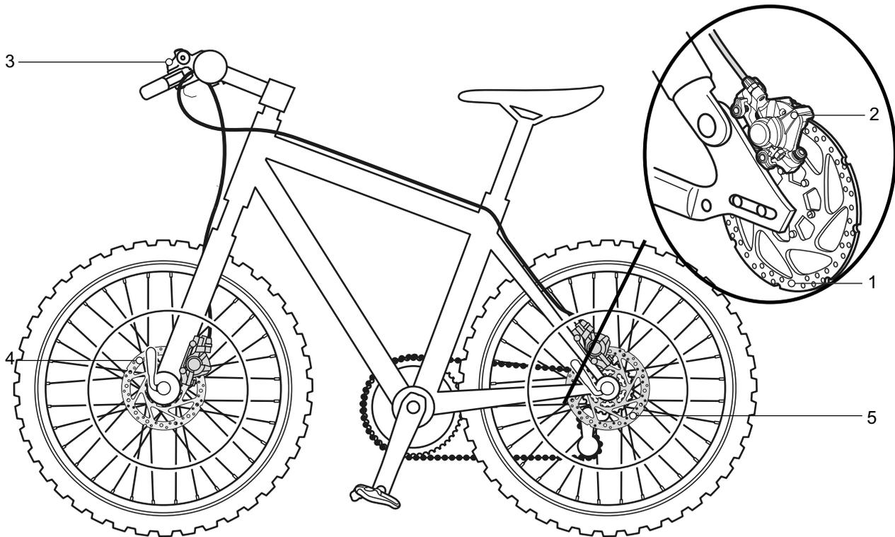
Figura 42: Sistema de frenado con freno de disco, ejemplo
