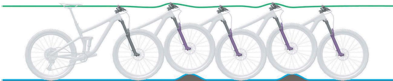
Figura 15: Condición óptima de marcha de la horquilla
