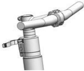
Figura 179: Ejemplo de All Up con palanca tensora de la potencia abierta
