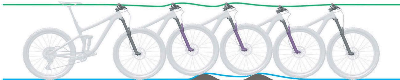
Figura 222: Descompresión demasiado lenta de la horquilla de suspensión
