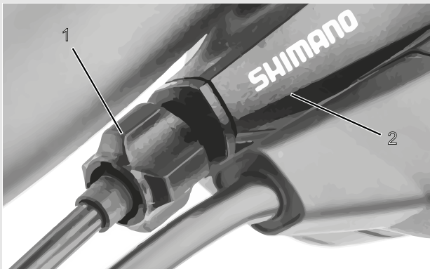
Afbeelding 87: Afstelwartel (1) van de versnelling met enkele bowdenkabelbediening en behuizing van de schakelhendel (2), voorbeeld
