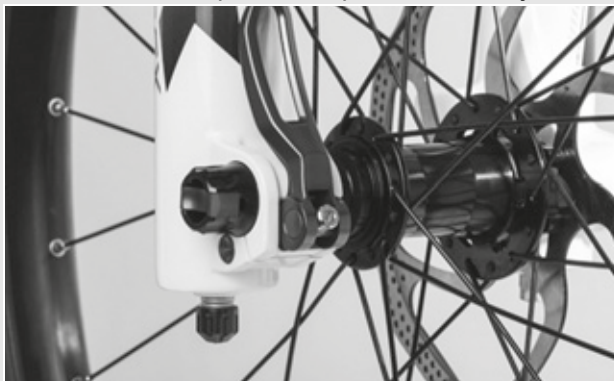
Afbeelding 36: Perfecte stand van de spanhendel
