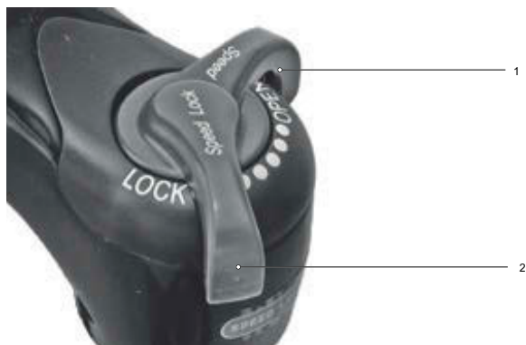
Afbeelding 158: Suntour drukdemperafsteller met de standen OPEN (1) en LOCK (2)
