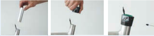
Afbeelding 258: Glijbus en buitenhuls monteren
