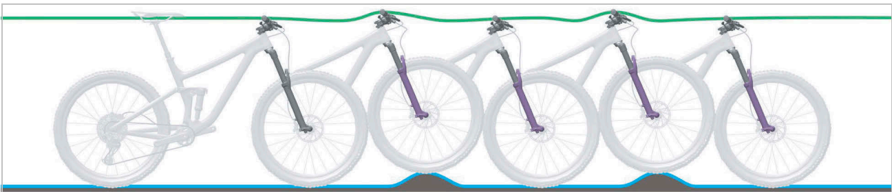
Afbeelding 13: Optimaal rijgedrag van de verende voorvork
