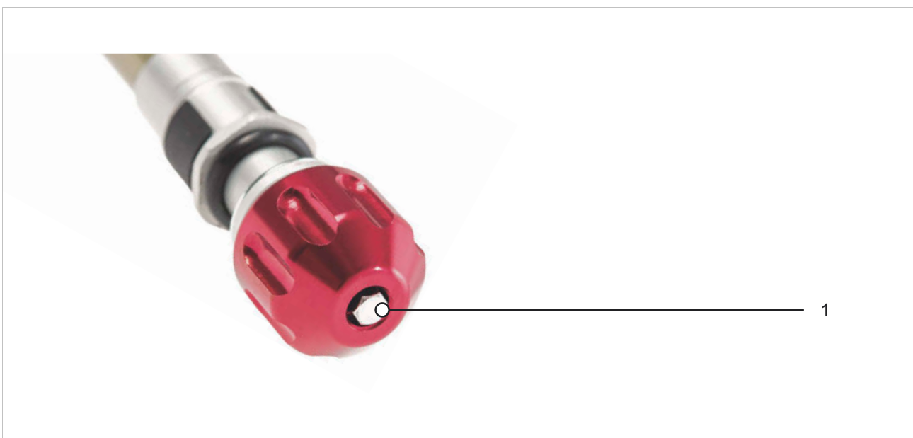
Afbeelding 267: Voorbeeld SR SUNTOUR trekdemperafsteller (vork) (1)
