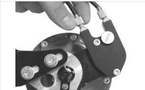
Afbeelding 195: Bij ROHLOFF naafversies met externe schakelaansturing zit de kabelafsteller op de kabelbox aan de linkerkzijde
