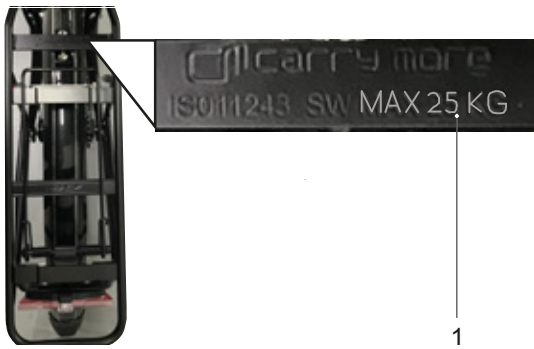
Figura 101: Identificar la capacidad máxima de carga (1) sobre el portaequipajes
