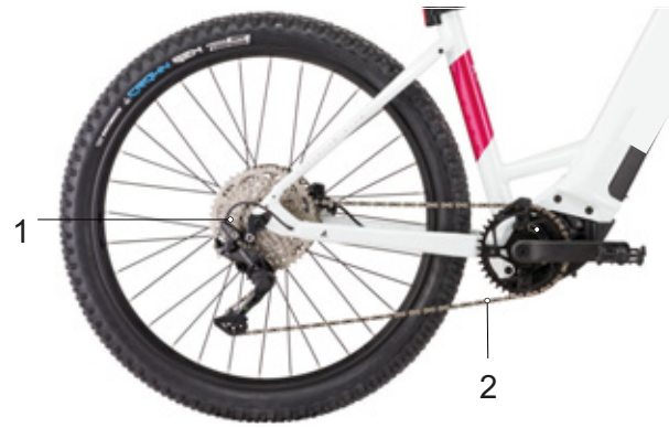
Figura 23: Esquema de la transmisión por cadena con cambio de cadena
