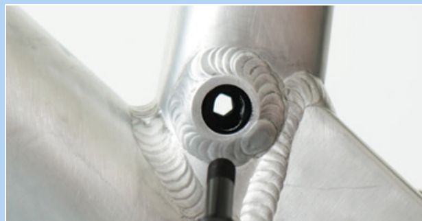
Figura 198: Orificio de la interfaz Postpin
