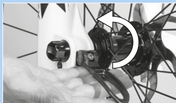
Figura 48: Presión de la palanca de cierre rápido en la dirección de la flecha
