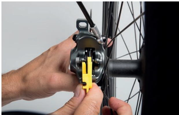
Abbildung 149: Bremsbelag im eingebauten Zustand mithilfe der Transportsicherung prüfen
