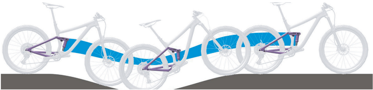
Abbildung 235: Zu weiche Federung des Hinterbau-Dämpfers am Berg
