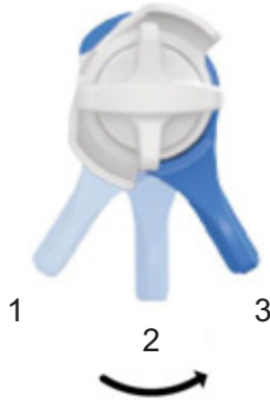
Figura 89: Ajuste de la palanca de 3 vías desde la posición cerrada (1), pasando por la posición media (2) hasta la posición abierta (3)
