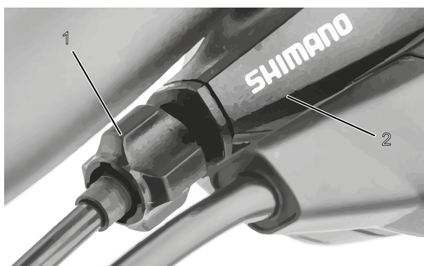
Figura 153: Casquillo de ajuste (1) del cambio de marchas accionado por cable de accionamiento con carcasa de la palanca de cambio (2), ejemplo
