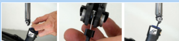
Figura 217: Enganchar e insertar la tija de sillín
