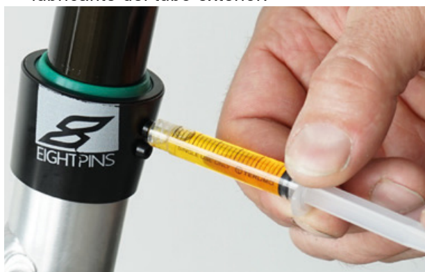
Figura 144: Lubricación del tubo de la tija de sillín
