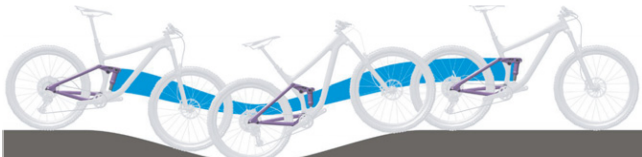
Figura 235: Suspensión del amortiguador de la horquilla trasera demasiado blanda en montaña
