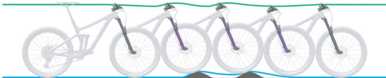
Figura 223: Descompresión demasiado lenta de la horquilla de suspensión
