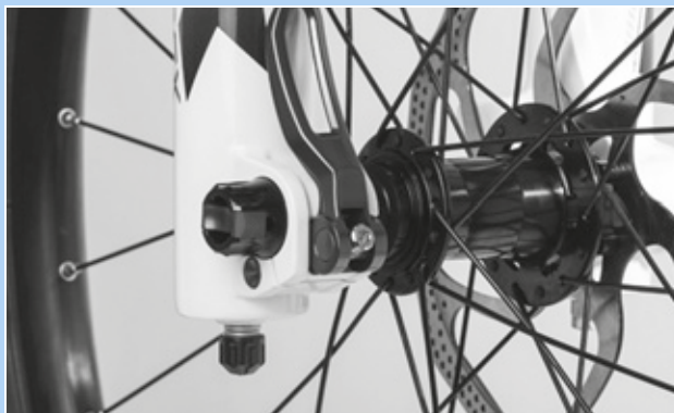
Figura 156: Ajuste de la fuerza de tensado del cierre rápido
