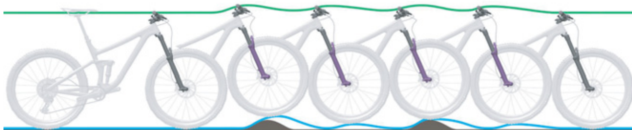
Figura 128: Descompresión demasiado rápida de la horquilla de suspensión
