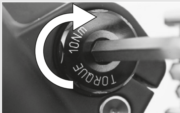
Figura 52: Apriete del eje insertado
