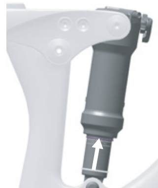
Figura 84: Desplazamiento de la junta tórica en el amortiguador de la horquilla trasera
