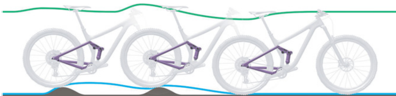
Figura 138: Descompresión demasiado lenta del amortiguador de la horquilla trasera
