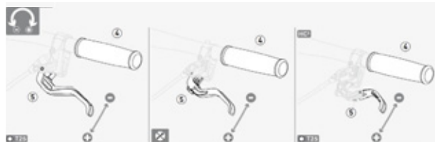
Figura 75: Ajustar el ancho de agarre de la palanca de freno con freno de disco Magura
