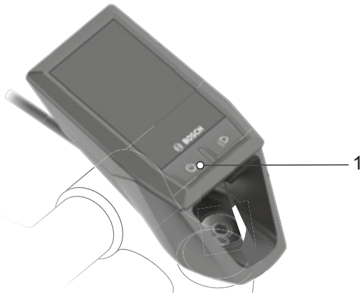
Figura 107: Posición del botón de conexión/desconexión (ordenador de a bordo)
