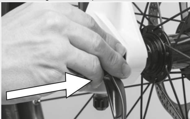
Figura 61: Inserción del cierre rápido
