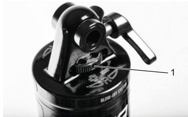
Figura 88: Rueda del regulador de niveles de tracción Suntour (1) en el amortiguador de la horquilla trasera
