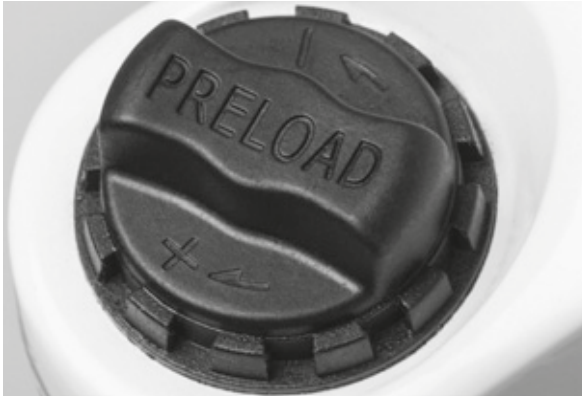
Figura 77: Rueda de ajuste SAG en la corona de la horquilla de suspensión
