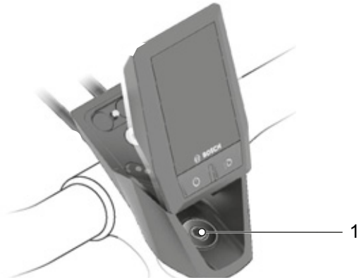
Figura 105: Posición del tornillo del juego de control
