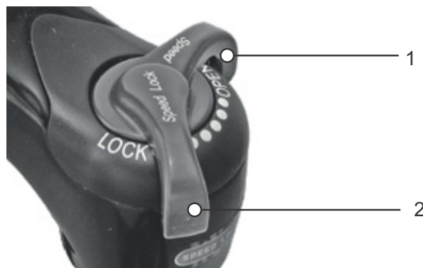
Figura 116: Amortiguador de niveles de presión Suntour en posición abierta (1) y cerrada (2)
