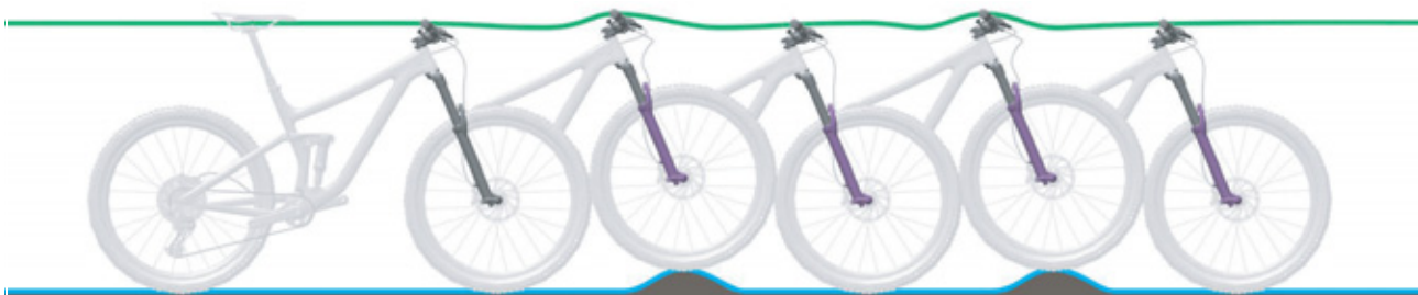
Figura 85: Condición óptima de marcha de la horquilla
