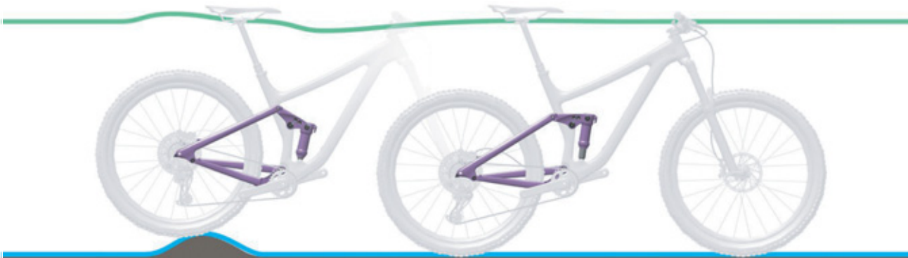
Figura 93: Condición óptima de marcha del amortiguador de la horquilla trasera en caso de irregularidades
