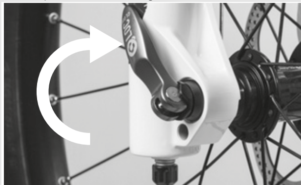
Figura 63: Cierre del cierre rápido
