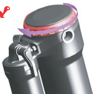
Figura 137: Giro del amortiguador de niveles de tracción en dirección a la tortuga
