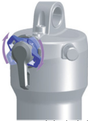
Figura 141: Ajuste para un regulador de niveles de presión más duro
