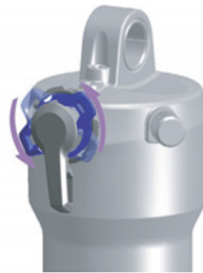
Figura 96: Ajuste para un regulador de niveles de presión más blando
