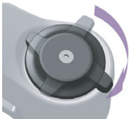
Figura 133: Ajuste para un regulador de niveles de presión más duro
