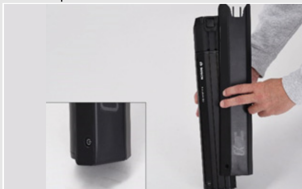
Figura 47: Desplazamiento de la cubierta de la batería sobre la batería
