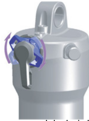
Figura 95: Ajuste para un regulador de niveles de presión más duro
