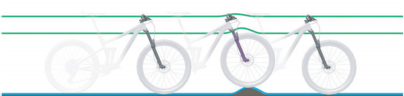
Figura 7: Condición óptima de marcha de la horquilla en caso de irregularidades
