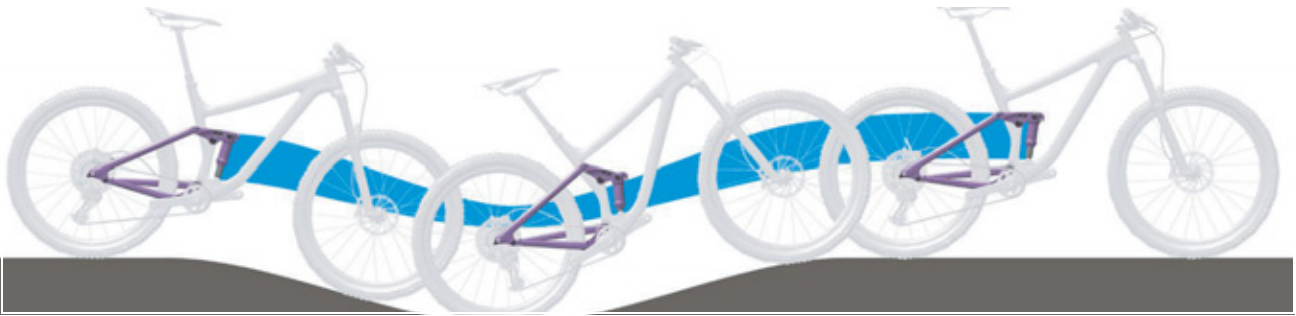
Figura 140: Suspensión del amortiguador de la horquilla trasera demasiado blanda en montaña
