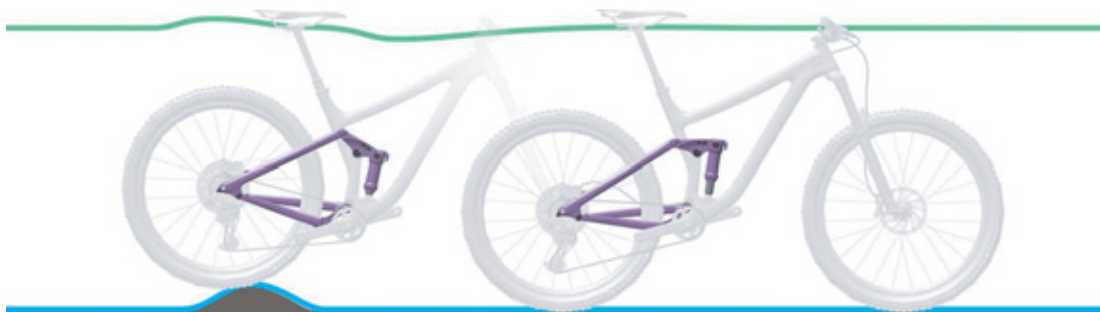
Figura 12: Condición óptima de marcha del amortiguador de la horquilla trasera en caso de irregularidades
