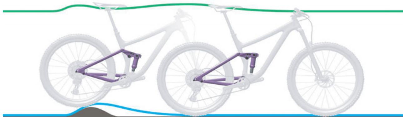
Figura 142: Amortiguación del amortiguador de la horquilla trasera demasiado dura en caso de irregularidades
