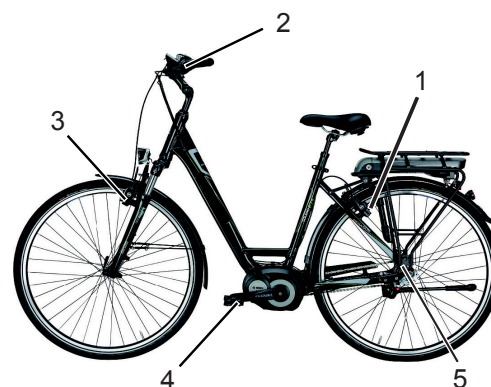
Abbildung 12: Bremssystem eines Pedelecs mit einer Rücktrittbremse, Beispiel
